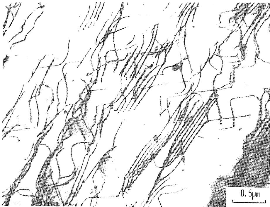
Figure III-2 : Vue générale d'arrangements de dislocations dans des interfaces inclinées dans l'alliage 221 vieilli 200h sans contrainte à 1050 °C. La normale à la lame est  $\{110\}$ . (MET 300kV, photo J.C. Van Duysen, EDF)
