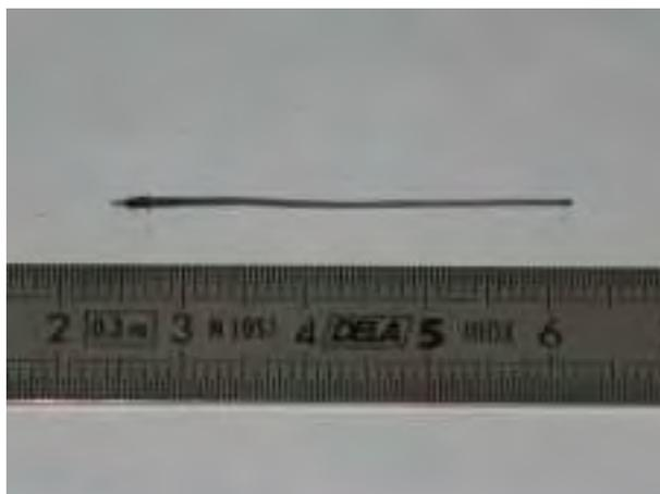
Figure IV. 46 : Photographie de la tige carbonée recueillie au niveau de la torche plasma.
