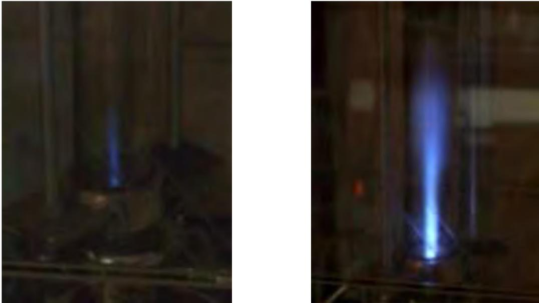
**Figure III. 35 : Photographies du plasma pour des débits d'arcél 21 égaux à 93 NI/h (à gauche) et 140 NI/h (à droite). Conditions opératoires : source électrotechnique avec une tension de sortie de 2500 V, résistance de ballast égale à 4700  $\Omega$ , tuyère cylindrique de longueur L = 50 mm.**
