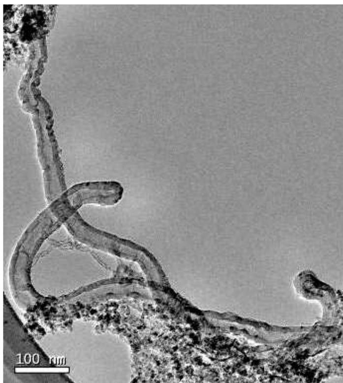
Figure IV. 36 : Cliché MET d'un échantillon synthétisé contenant des nanotubes de carbone multiparois de diamètres hétérogènes.
