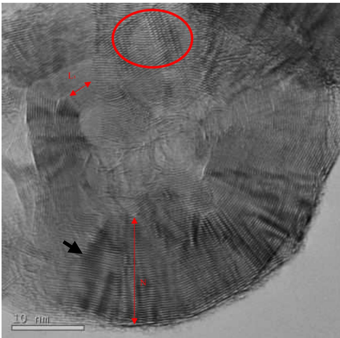
Figure IV. 14 : Cliché MET de la coque carbonée.
