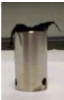
**Figure IV. 52 : Photographie réalisée à la fin d'un essai expérimental et présentant une tuyère cylindrique avec des dépôts solides.**
