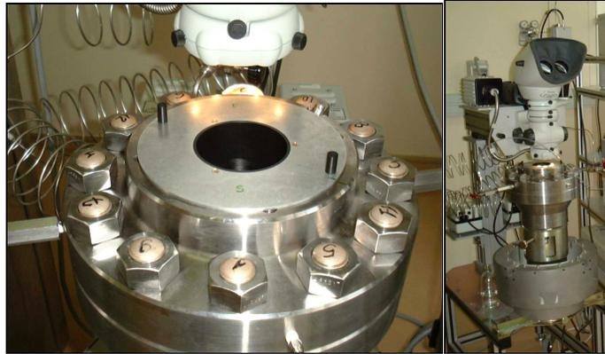
**Figure 80 : Cellule de confinement pour le micromodèle.**
