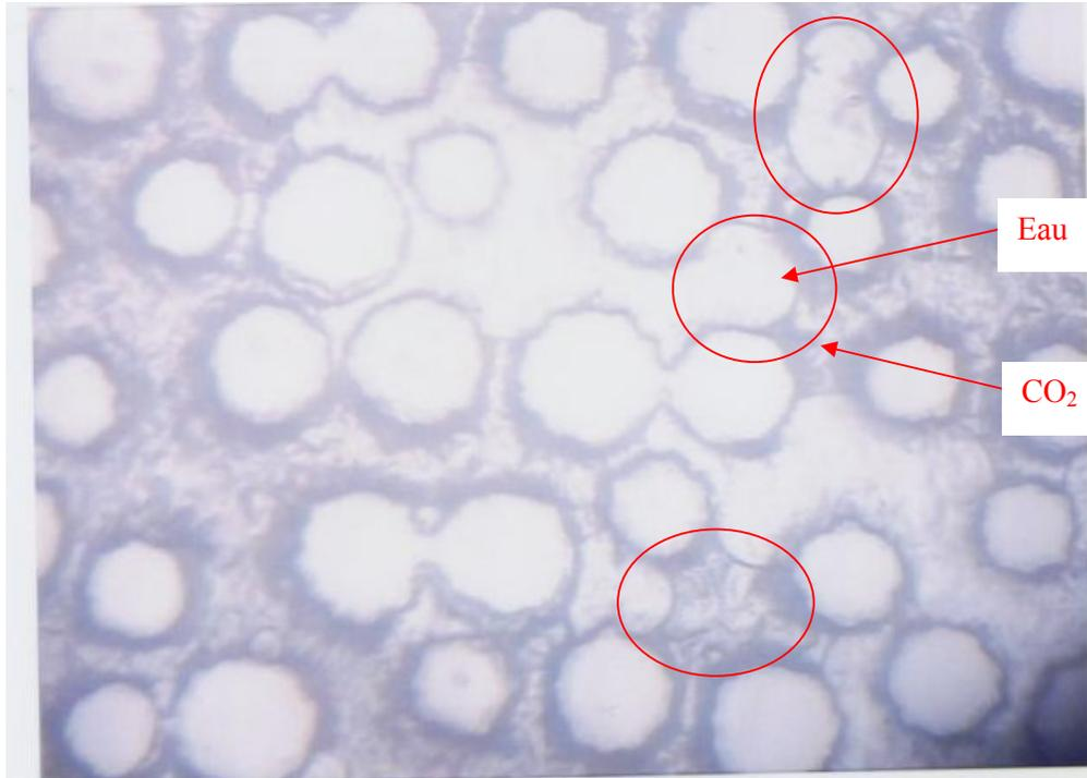
**Figure 93 : Micromodèle hétérogène IW saturé brut. P = 100 bar, T = 60°C.**
