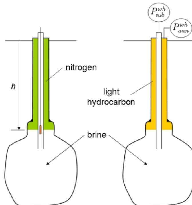
FIG. 3.7 – Essai NLT (gauche) et LLT (droite)
