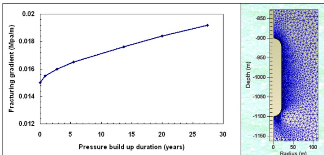
FIG. 2.42 – Gradient de fracturation 20 ans après la création de la caverne (à gauche) et le maillage d'éléments finis (à droite)
