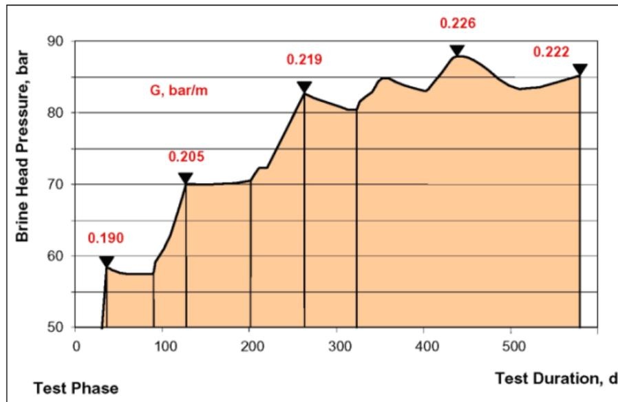
FIG. 2.41 – Historique de la pression dans l'essai d'Etzel
