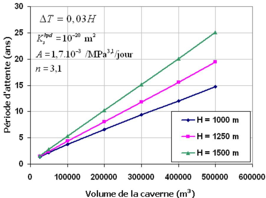
FIG. 4.3 – Période d'attente minimum pour éviter la fracturation.
