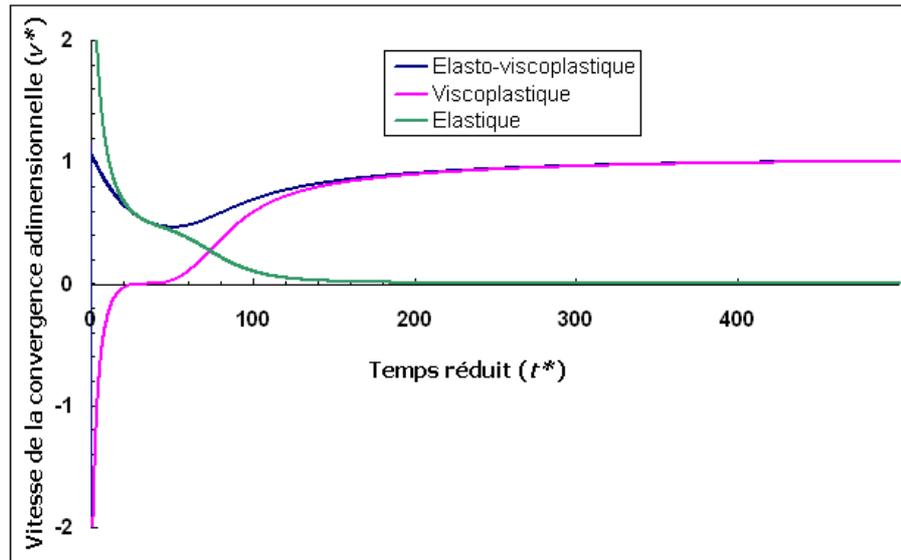
FIG. 2.25 – Composants élastique et viscoplastique de la vitesse de convergence à la paroi.
