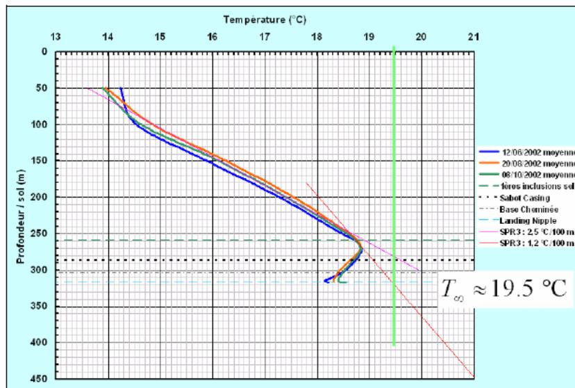
FIG. 4.23 – Profil géothermique du puits SPR2.
