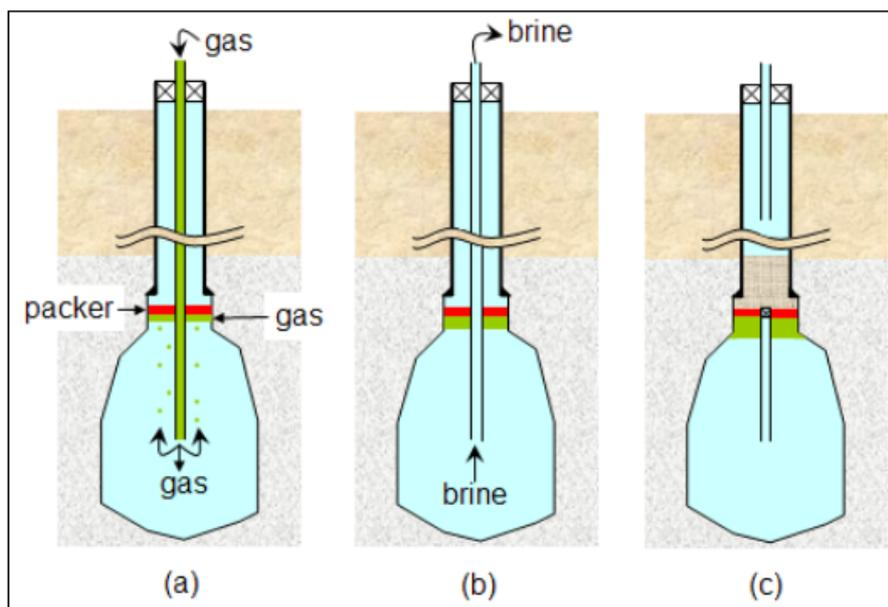
FIG. 4.7 – Le gaz est injecté en-dessous de packer (a) ; la saumure sort en décompressant la caverne (b) ; le tube central est fermé et du ciment remplit le puits (c) (Bérest et al., 2006 [23]).
