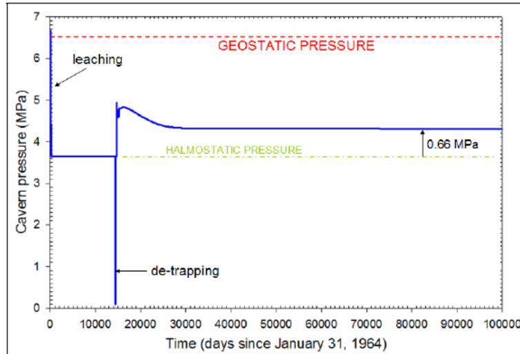
FIG. 4.36 – L'évolution de la pression dans la caverne à long terme dans le cas  $n = 5$ ,  $A = 7,8$  /MPa<sup>5</sup>/an et  $K_s^{hyd} = 4.10^{-20}$  m<sup>2</sup>.
