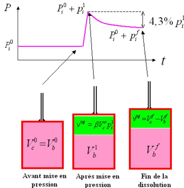
FIG. 3.6 – Schéma de la dissolution complémentaire.
