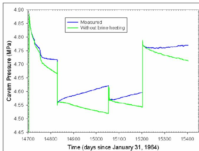
FIG. 4.37 – Evolution de la pression dans la caverne avec et sans l'effet thermique
