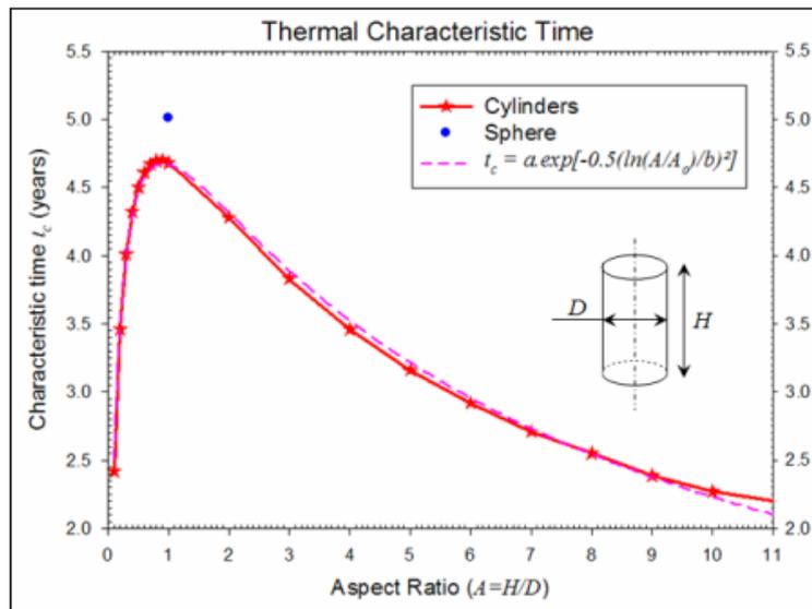
FIG. 3.4 – Temps caractéristique thermique dans une cavité cylindrique de 100.000 m<sup>3</sup> de volume.
