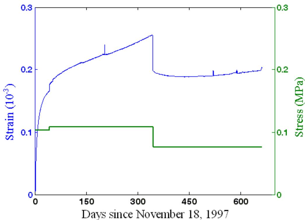
FIG. 1.11 – Evolution de la déformation sous faibles contraintes au cours d'un essai de compression uniaxiale (Bérest et al., 2004).
