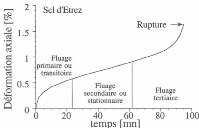
FIG. 1.18 – Essai de fluage en compression simple (Charpentier, 1983).
