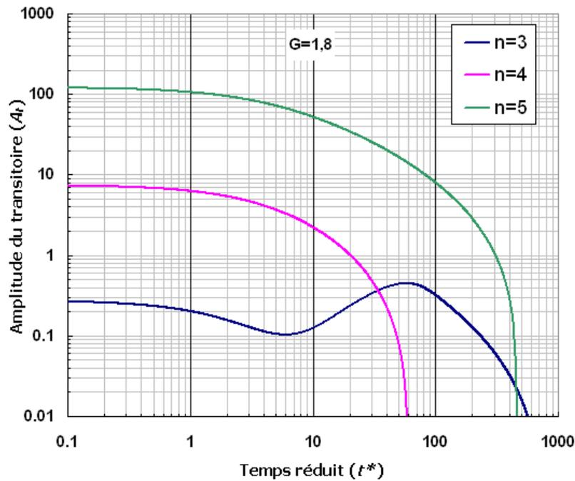
FIG. 2.18 – Abaques donnant l'amplitude du transitoire (écart relatif à la vitesse stationnaire) en fonction du temps pour le gradient  $G = 1,8$
