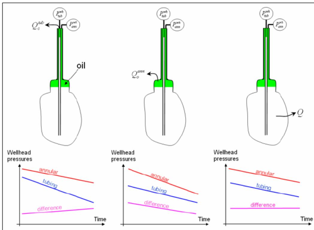
FIG. 4.18 – Principe de la détection de fuite.
