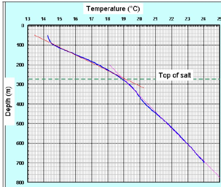
FIG. 4.22 – Profil géothermique du puits SPR3.
