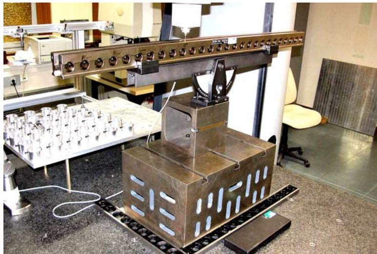
Figure 22 : Photo de montage de la KOBA pour la détermination des défauts de la machine
