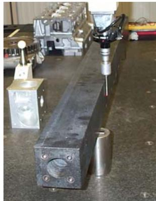
Figure 13 : Mesure du coulisseau après prise d'humidité
