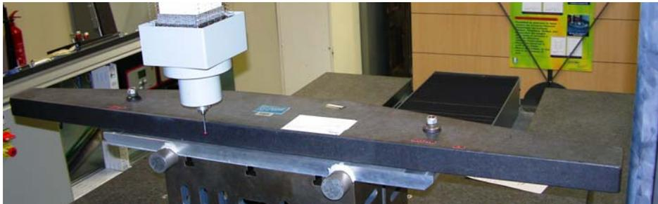
Figure 3 : Photo d'une règle de rectitude en granit munie de son support
