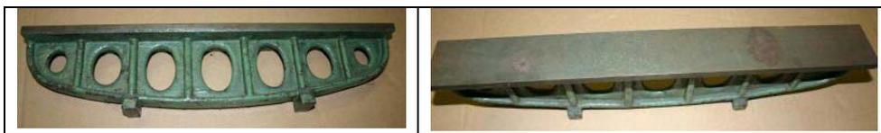
Figure 4 : photos d'une règle « limace » de mécanicien
