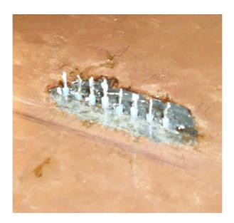
Fig. I.36 – Photo du réseau fait de 8 antennes non radiatives, espacées de 4 mm.
