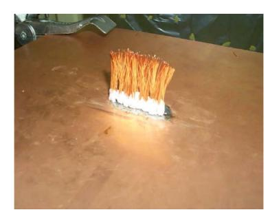
Fig. I.37 – Photo du réseau d'antennes non radiatives avec couronnes de diffuseurs, que nous qualifierons par la suite d'antennes microstructurées.
