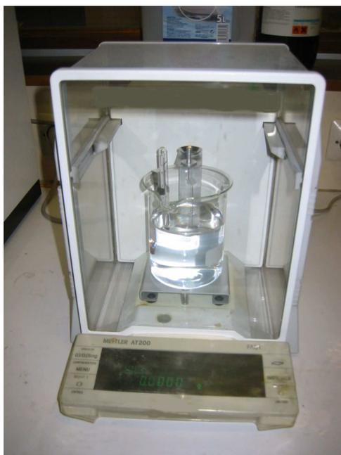
FIG. 4.2 – Balance-picnomètre Mettler AT200.
