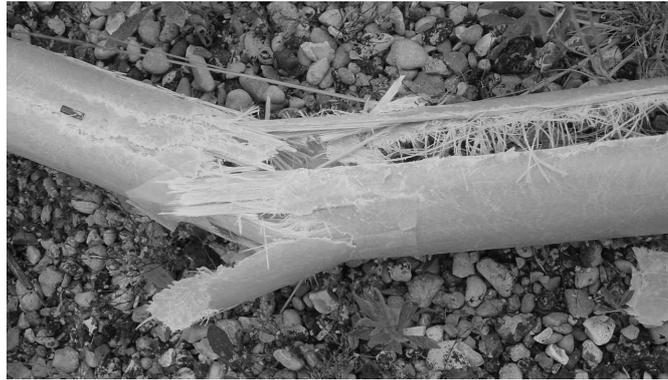
FIG. 2.16 – Rupture caractéristique d'un tube fléchi.
