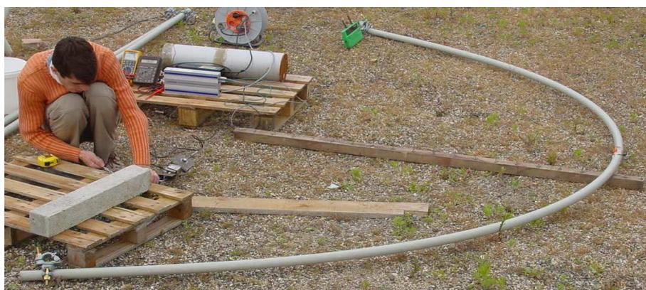
FIG. 2.13 – Protocole expérimental pour l'étude des tubes composites en grande transformation.
