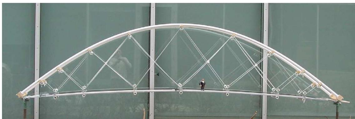
FIG. 2.5 – Maquette de la passerelle tout composite développée au LAMI.
