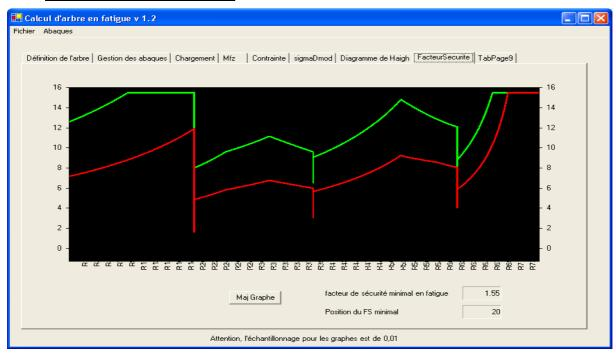
Visualisation de la courbe des facteurs de sécurité en fatigue et en statique, détection du facteur de sécurité minimal ainsi que de sa position.
