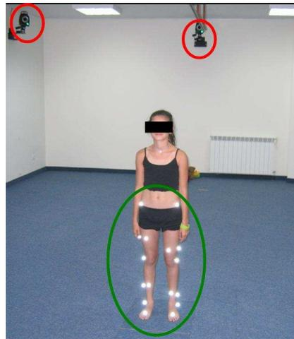
**Figure 16 - Capture de mouvement par système optoélectronique : caméras émettrices/réceptrices d'infrarouge et marqueurs et réfléchissants.**
