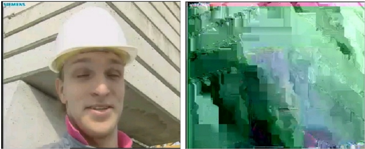
FIGURE 2.17 – Résultats visuels décryptés et cryptés de la 1 re image de la séquence 'Foreman' (QCIF, QP=30)
