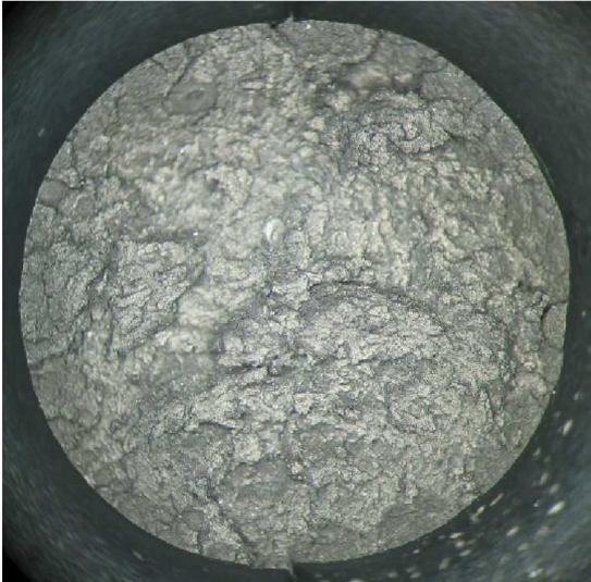
FIGURE 9.9 – Faciès de rupture d'AE2 à 5°C (NR).
