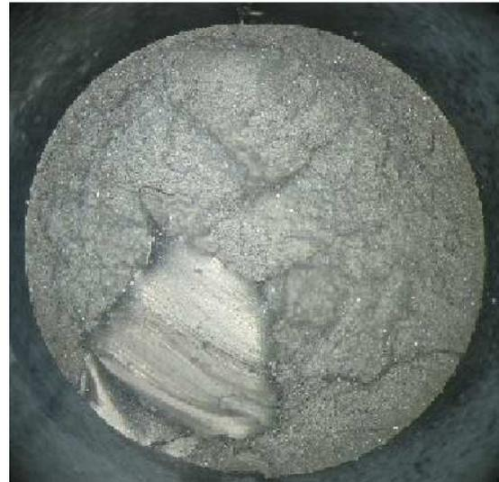
FIGURE 9.10 – Faciès de rupture d'AE2 à 85°C (NR).
