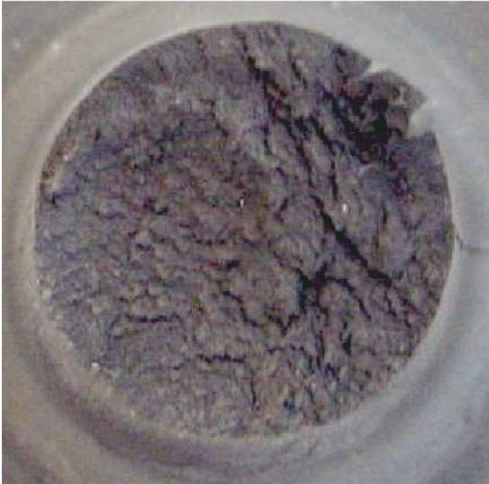
FIGURE 9.7 – Faciès de rupture d'AE42 pour un NR.
