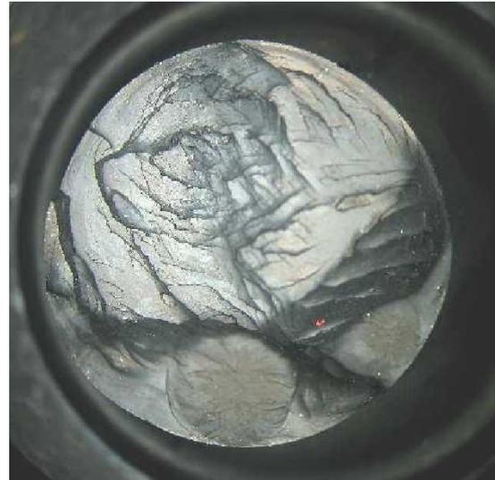
FIGURE 9.8 – Faciès de rupture d'AE42 pour un SBR.
