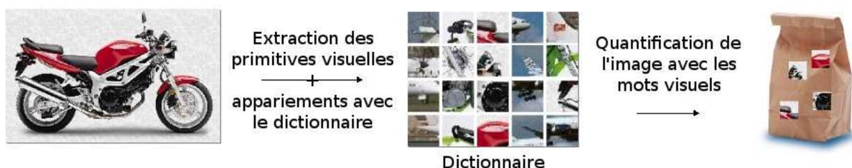
FIG. 1.24: Représentation d'une image selon le paradigme des sacs de mots visuels. Les primitives extraites dans l'image courante sont mises en correspondance avec les mots du dictionnaire pour décrire l'image en fonction de l'occurrence de ces mots.
