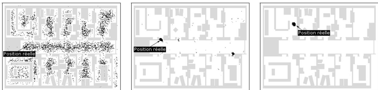
FIG. 1.15: Illustration de la convergence du processus de localisation globale MCL : au départ, les particules sont dispersées sur toute la carte, avant de se concentrer au fur et à mesure des déplacements et des observations sur la position réelle. Source : [Fox et al., 1999].
