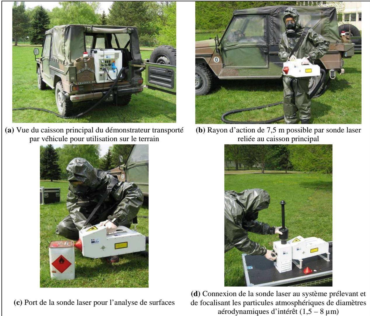
figure V-8 : Photographies des composants et des configurations du démonstrateur opérationnel LIBS
