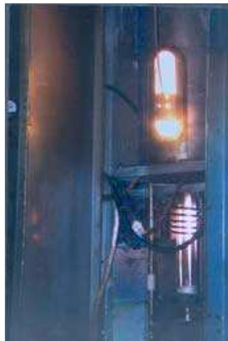
Photo 5 : Dispositif de traitement de poudre à contre courant: torche de puissance 70 kW, institut polytechnique de S<sup>t</sup> Petersburg
