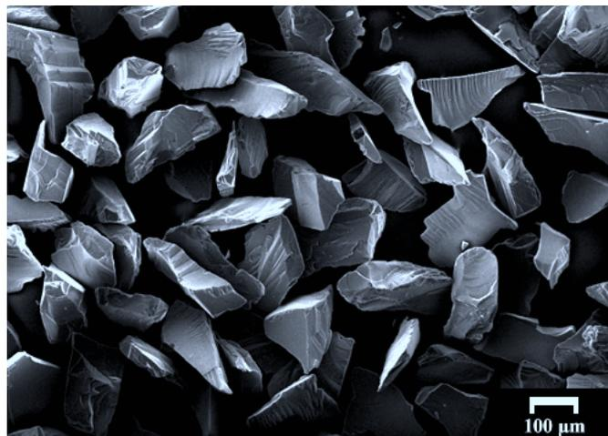
Figure 2 : Analyse de la morphologie de la poudre de départ par MEB
