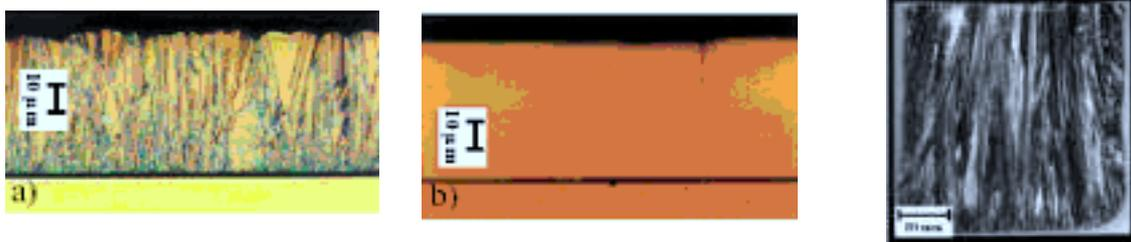
Figure 15 : Evolution de la morphologie des dépôts après recristallisation : a) avant recuit, b) après recuit, c) aspect des grains du dépôt de silicium sur une surface de 5x5  $\text{cm}^2$  d'un substrat de mullite<sup>[25], [27]</sup>
