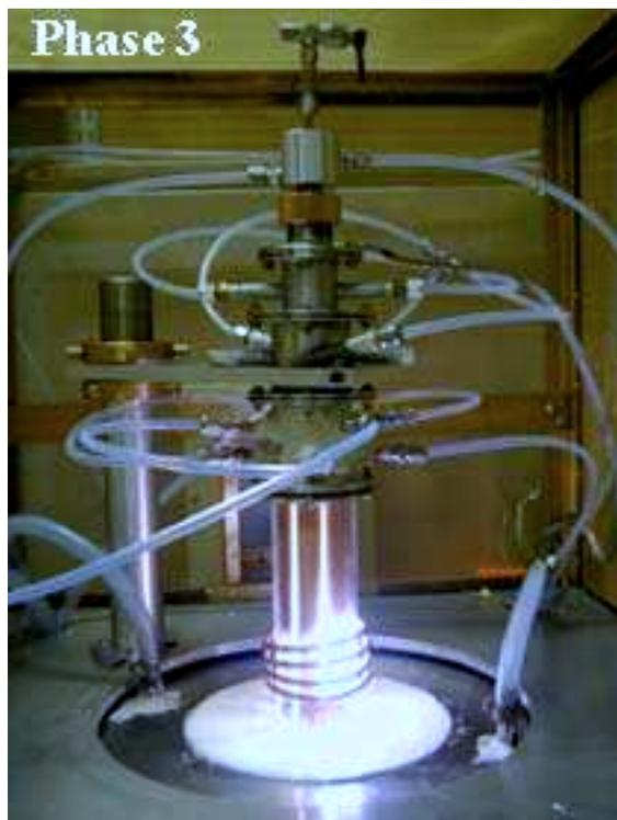
**Photo 2: Le plasma thermique à P=1atm ; Phase 3: Régime permanent**
