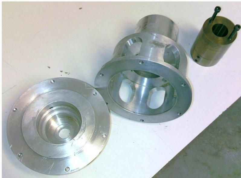
*Fig. II.17 –Base inférieure et tube supérieur (Aluminium), tube guidage (laiton)*
