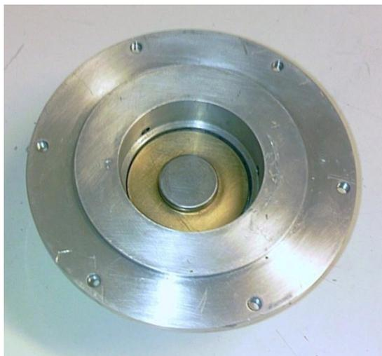
*Fig. II.15 –Base inférieure avec bouchon et anneau montés*
