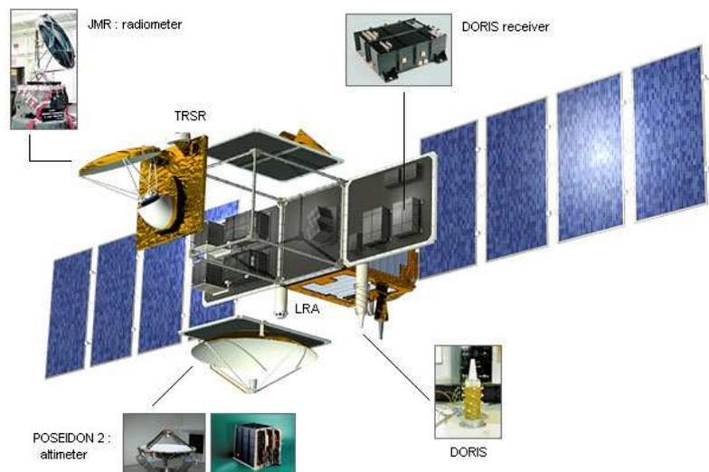
FIG. 1.8: Le satellite altimètre Jason-1. (Document CNES)
