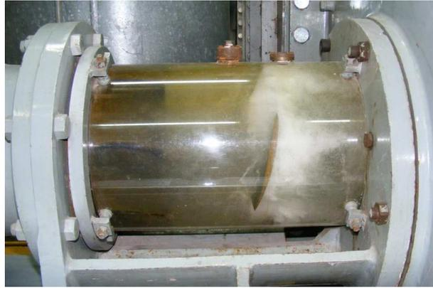
Figure V-2 : Forte cavitation créée sur les pales de la pompe à hélice,  $\omega=1500$  tr/min et  $P_{\text{cuve à vide}}=200$  mbar.
