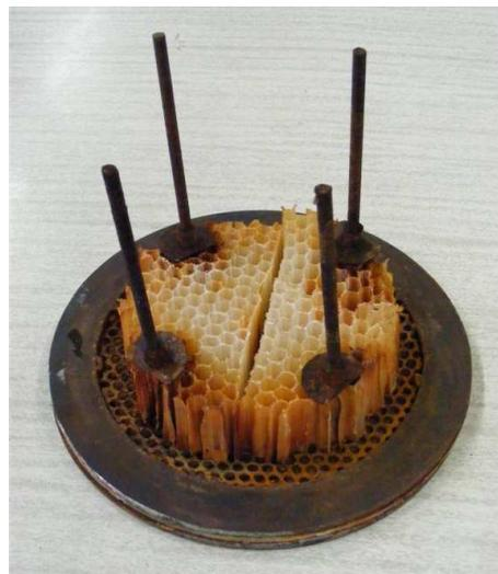
Figure II-11 : dispositif « diaphragme-grille-nid d'abeille »
