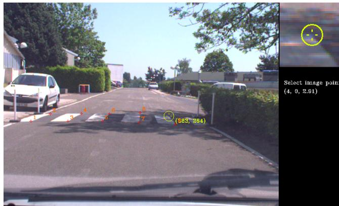
FIG. 5.2 – Sélection des points d’un amer contenu dans le plan de l’espace navigable, et dont les coordonnées 3-D sont connues, pour la calibration des paramètres extrinsèques de la caméra.
