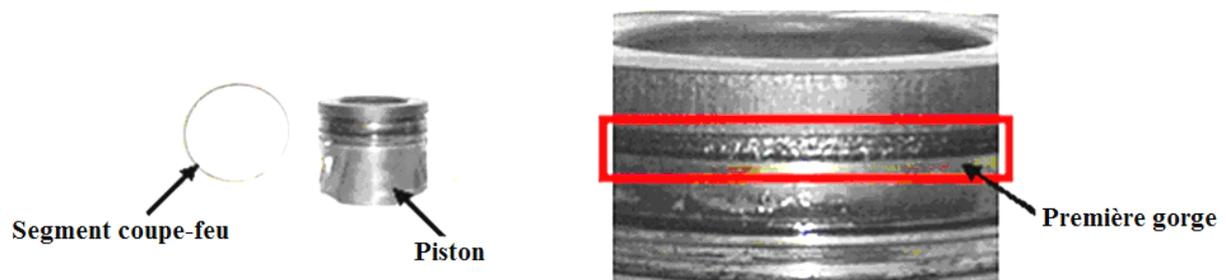
Figure II-1. Photo du piston DW12B du test d'endurance de 200h
