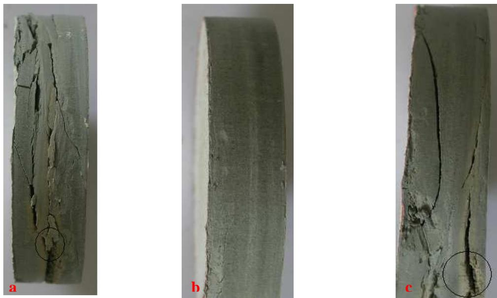
Figure 4.4.4 : Eprouvettes de Marnes bleues d'Argenteuil (EMBA-01) après une première phase d'imbibition totale et de séchage complet : a) Ech-I, b) Ech-II, c) éch-III. Les cercles montrent les lits de matériau plus argileux
