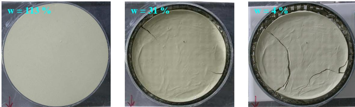
Figure 5.1.8 : Séchage EAVR-0 remanié D= 185 mm, e= 20 mm
