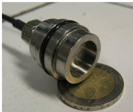
Figure II.6. Tensiomètre de haute capacité
