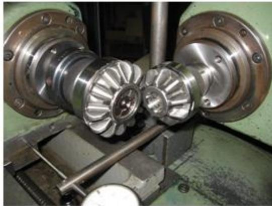
*Figure 2-36 – Engrenage contrôlés sur banc d'engrènométrie [Berviller 2006].*
