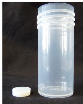
Figure A.2 – Photos représentant un monolithe de silice contenant encore les billes de polymère, après que tout le solvant ait été expulsé et se soit évaporé. A côté, se trouve le flacon ayant servi de *moule* pour la formation du monolithe.
