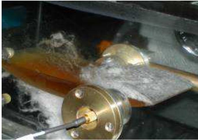
*Figure 1.2* — Cavitation par poche attachée obtenue sur un foil convexe (ENSTA)
