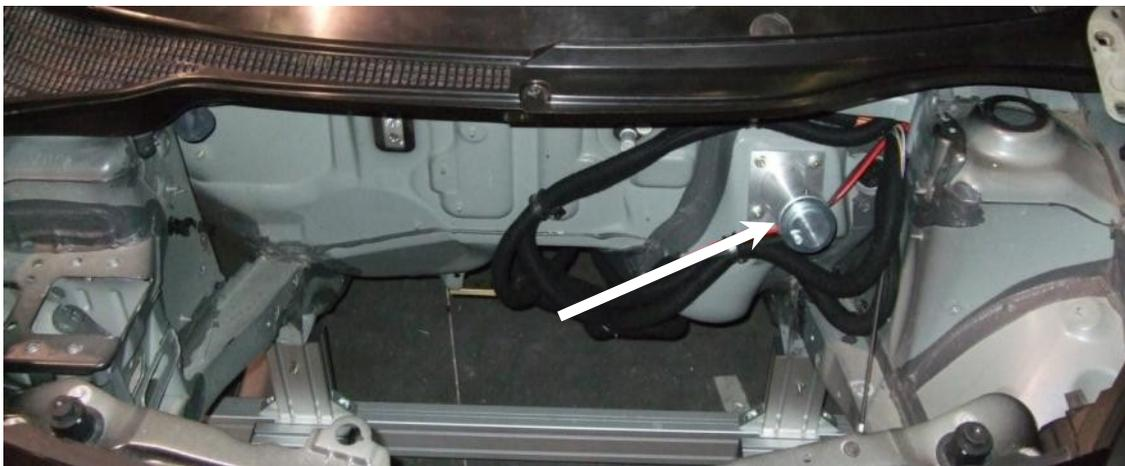
*Figure 64 – Système à retour d'effort passif pour la pédale de frein du simulateur SAAM. Fixé derrière le plancher sous le pédalier, il apparaît dans l'ancien compartiment du moteur.*
