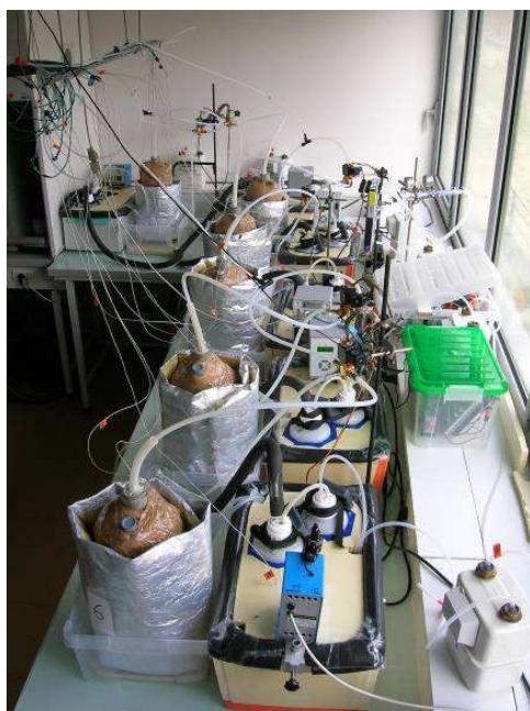
Schéma et photographie du dispositif de compostage miniaturisé (utilisé les 41 premiers jours du compostage) comprenant 6 réacteurs fonctionnant en parallèle, sans utilisation de marquage <sup>14</sup>C.
