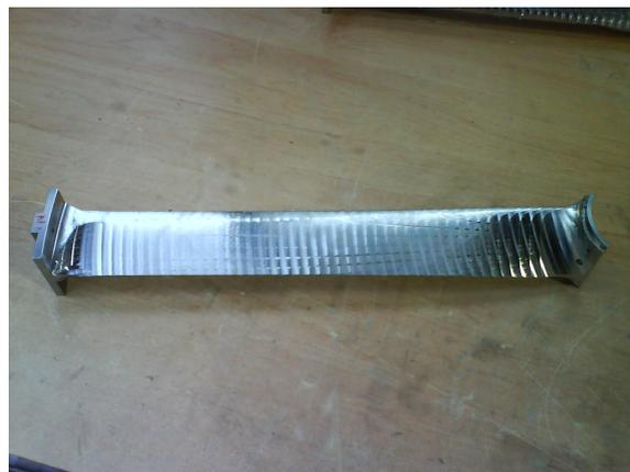
Figure 3.4.3.A : Une des 5 pales en cours d'usinage – source IRENav
