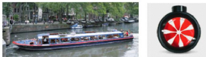
Figure 1.1.2.Y : Exemple d'un bateau, le Barleaus - Blue Boat Company, équipé de propulseurs RD développés par Voith Hydro.
