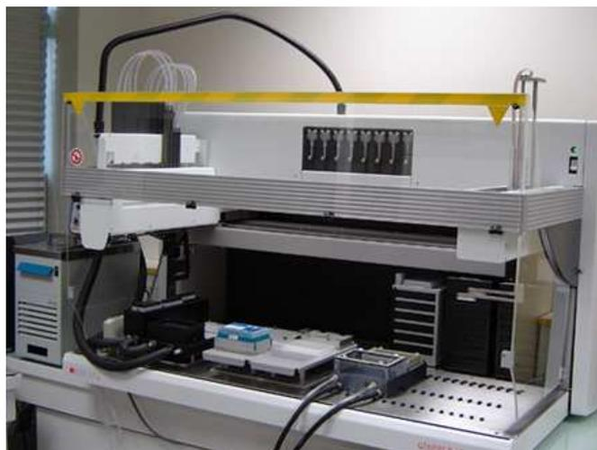
Figure 74 : Robot pipeteur/manipulateur Genesis Proteam 150
