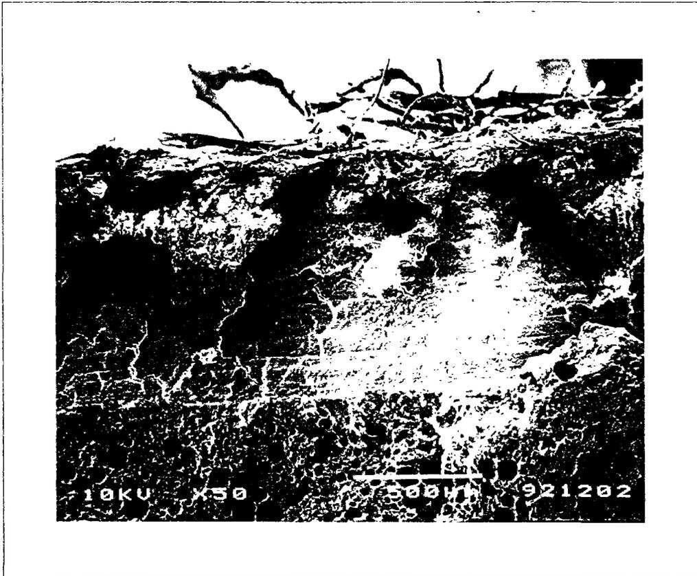
Photo III.1 : Vue au microscope électronique à balayage de l'interface " coeur-carton "
