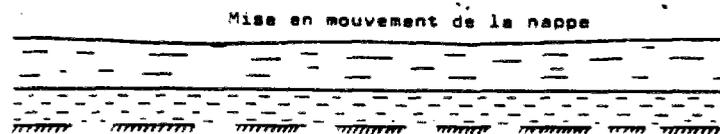
Phase III : Saturation et effondrement des structures au dessus d'un plan de discontinuité de plus en plus marqué.
