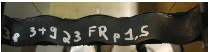
FIG. 1.9: Flambement de la nappe sous flexion circulaire (d'après (Caillard, Michelin))
