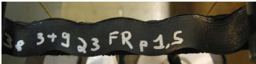
FIG. 10.16: Flambement sous flexion circulaire observé expérimentalement (d'après (Caillard, Michelin)).
