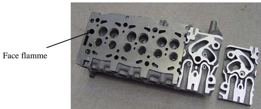
Figure 2.15. Culasse moteur diesel de la société PSA
