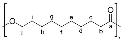
60 mg d'un solide marron sont obtenus à partir de décane-1,10-diol (0.5 mmol) selon la procédure L (71%,  $\text{DP}_{\text{RMN}} = 170$ ).
