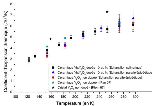
**Figure III - 14 : Coefficients d'élongation thermique de céramiques Yb:  $Y_2O_3$  dopées 10 at. % à basse température.**
