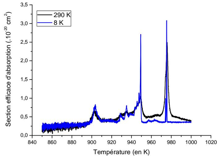
Figure B - 3 : Sections efficaces d'absorption d'une céramique Yb : Lu<sub>2</sub>O<sub>3</sub> dopée 10 at. % à 290 K (courbe noire) et à 8 K (courbe bleue).
