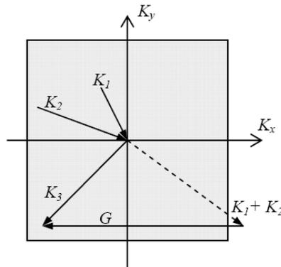
**Figure IV - 13 : Mécanisme de collision, de types Umklapp, entre phonons dans un réseau carré, en deux dimensions. Le carré grisé représente la première zone de Brillouin ; cette zone contient toutes les valeurs indépendantes possibles du vecteur d'onde des phonons.**
