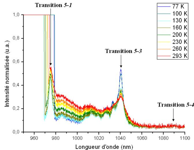
Figure II - 17 : Spectre de fluorescence de la céramique Yb : Sc<sub>2</sub>O<sub>3</sub> dopée 10 at. % en fonction de la température du support échantillon.
