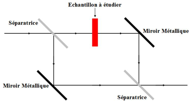
Figure III - 10 : Schéma de principe d'un interféromètre Mach-Zehnder.
