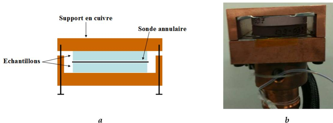
**Figure IV - 34 : a : Schéma du dispositif expérimental mis en place pour la mesure de la conductivité thermique par la méthode de la sonde annulaire à basse température. b : Photo du support échantillon avec deux échantillons de verre phosphate dopé néodyme.**
