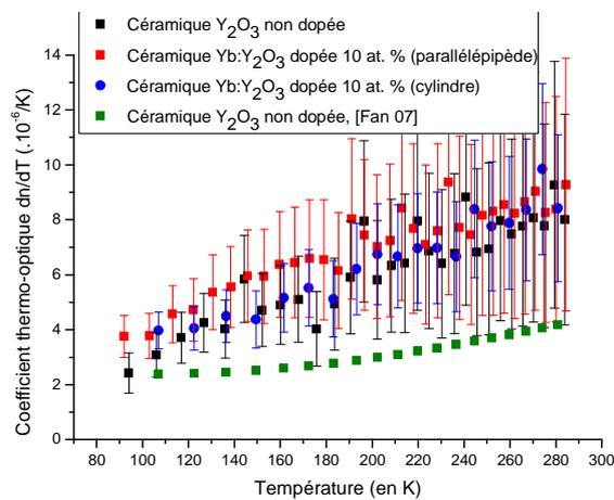
Figure III - 28 : Coefficients thermo-optiques de céramiques Y<sub>2</sub>O<sub>3</sub> non dopée et dopées 10 at. %, échantillons parallélépipédiques d'épaisseur 9,86 mm et cylindrique d'épaisseur 6,36 mm, d'indice de réfraction de 1,89 à la longueur d'onde de 632,8 nm.
