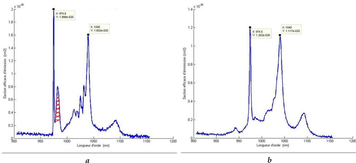
Figure B - 6 : Sections efficaces d'émission de Yb : Sc<sub>2</sub>O<sub>3</sub> dopée 10 at. % à 5 K (a) et à 294 K (b).
