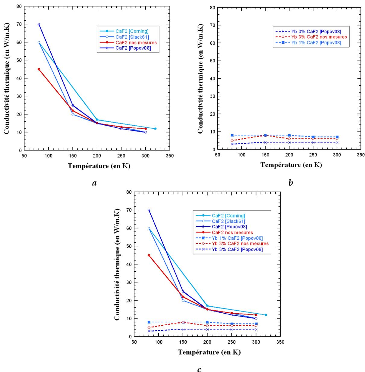
Figure IV - 31 : Conductivités thermiques obtenues pour des cristaux CaF<sub>2</sub> non dopé (a) et dopé ytterbium (b) à basse température. Ensemble des résultats regroupés (c).
