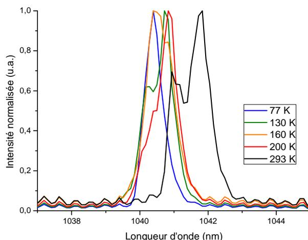
Figure II - 19 : Spectre émis par l'oscillateur laser Yb : Sc<sub>2</sub>O<sub>3</sub> en fonction de la température du porte échantillon.
