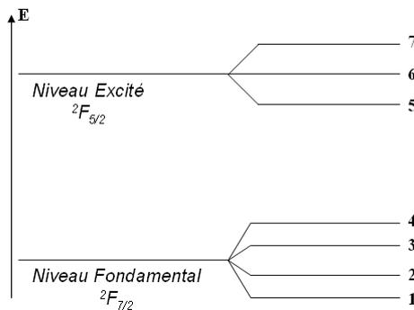
Figure I - 1 : Diagramme énergétique de l'ion ytterbium  $\text{Yb}^{3+}$ .
