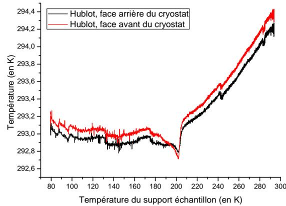
Figure III - 34 : Température à l'intérieur des hublots en fonction de la température du support échantillon, mesure en montée en température.
