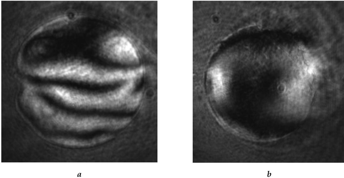
**Figure III - 42 : Déformations de la figure d'interférence obtenue en sortie de l'interféromètre Mach-Zehnder pour une céramique Yb :Y<sub>2</sub>O<sub>3</sub> dopée 10 at. %, à 77 K, en configurations du coin d'air (a) et de teinte plate (b).**
