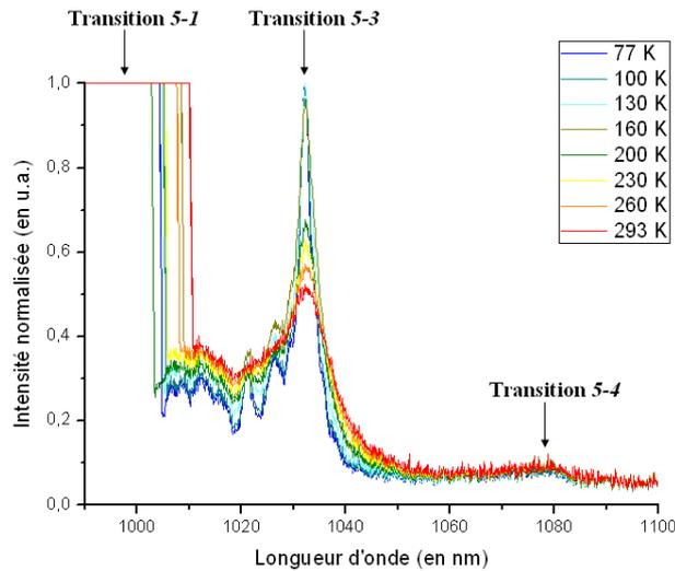
Figure II - 13 : Spectre de fluorescence de la céramique Yb : Lu<sub>2</sub>O<sub>3</sub> dopée 10 at. % en fonction de la température du support échantillon.
