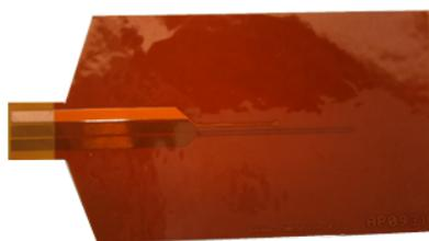
**Figure IV - 17 : Photo d'une sonde fil chaud.**
