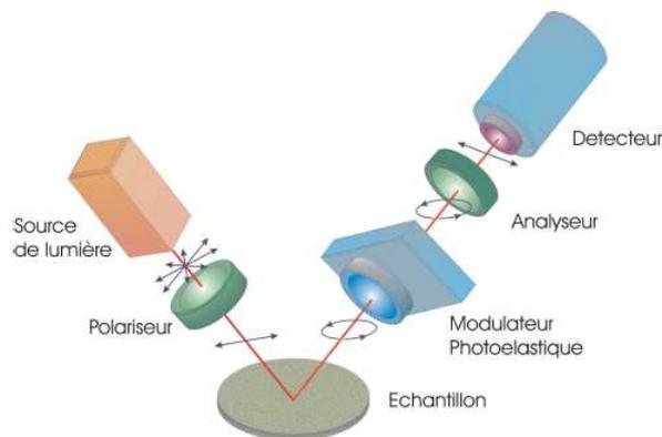
**Figure III - 8 : Ellipsomètre spectroscopique à modulation de phase.**
