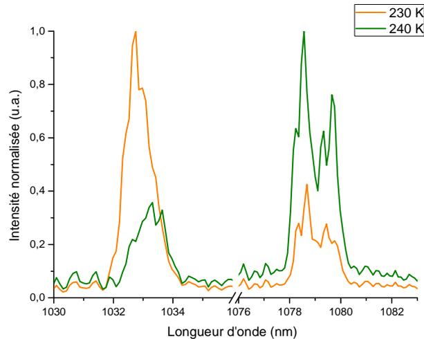
Figure II - 16 : Spectre émis par l'oscillateur Yb:Lu<sub>2</sub>O<sub>3</sub> à 230 K et 240 K.
