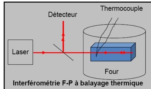
*Mesure du coefficient de variation de chemin optique*
