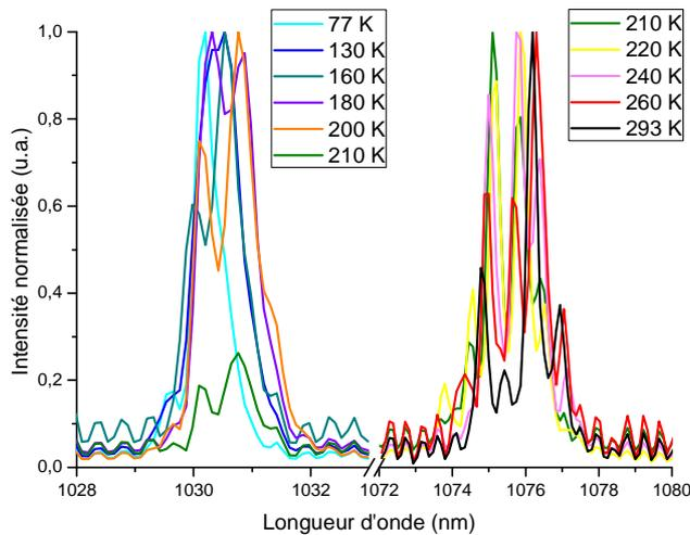
Figure II - 10 : Spectre émis par l'oscillateur laser Yb:Y<sub>2</sub>O<sub>3</sub> en fonction de la température du porte échantillon.
