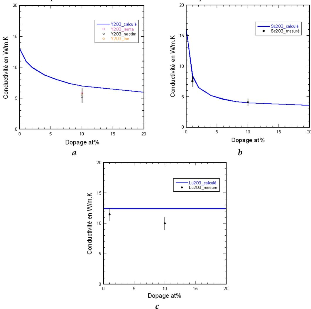
Figure IV - 36 : Conductivités thermiques mesurées pour des céramiques  $Y_2O_3$ ,  $Sc_2O_3$  et  $Lu_2O_3$  pour différents taux de dopage en ion ytterbium. Comparaison avec les résultats du modèle de Gaumé.
