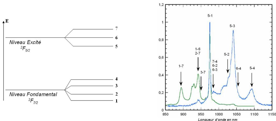
Figure I - 6 : Spectres d'absorption (courbe verte) et d'émission (courbe bleue) d'une céramique Yb : Sc<sub>2</sub>O<sub>3</sub> dopée 10 at. % à température ambiante.
