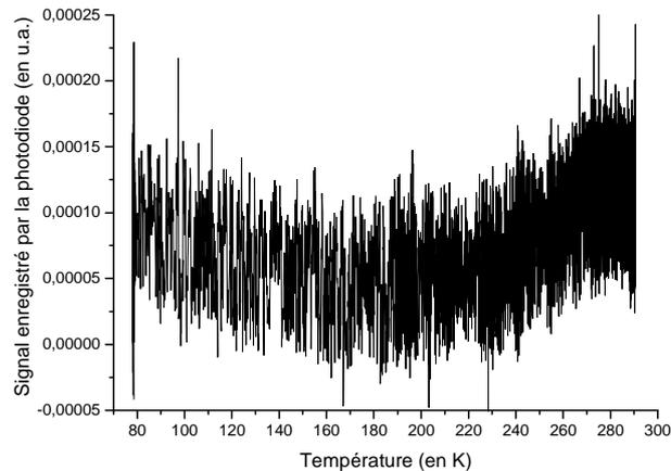
Figure III - 36 : Enregistrement du signal mesuré par la photodiode dans le cas où il n'y a pas d'échantillon dans le support.
