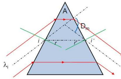
**Figure III - 4 : Schéma de propagation dans un prisme.**
