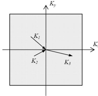
**Figure IV - 12 : Mécanisme de collision, de types normaux, entre phonons dans un réseau carré, en deux dimensions. Le carré grisé représente la première zone de Brillouin ; cette zone contient toutes les valeurs indépendantes possibles du vecteur d'onde des phonons.**
