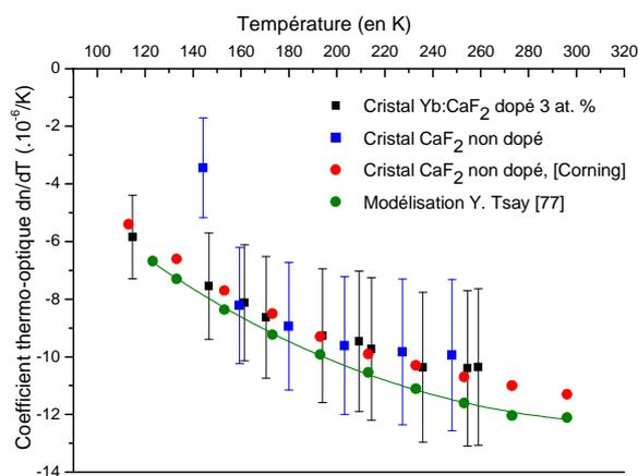
**Figure III - 32 : Coefficients thermo-optiques de cristaux CaF<sub>2</sub> non dopé et dopé à 3 at. %, d'épaisseurs 6,1 mm et d'indice de réfraction de 1,43 à la longueur d'onde de 632,8 nm.**
