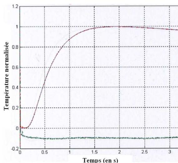
Figure IV - 16 : Thermogramme mesuré sur une céramique Yb :Y<sub>2</sub>O<sub>3</sub> dopée 10 at. % à température ambiante.
