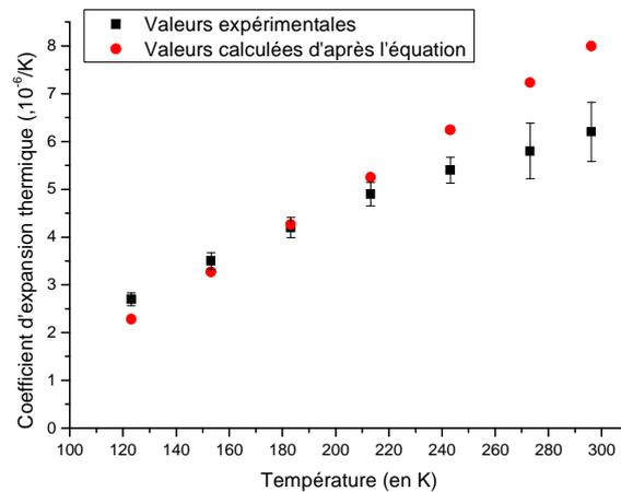
Figure III - 17 : Coefficients d'élongation thermique d'un cristal de YAG non dopé à basse température. Comparaison avec les valeurs d'élongation thermique calculées par la régression de Fan *et al.* [Fan 98].
