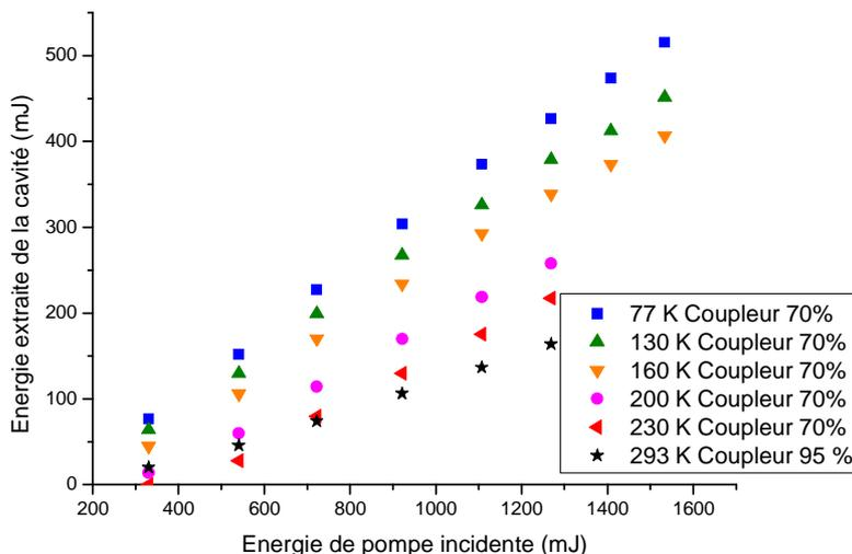
Figure D - 2 : Energies en sortie de l'oscillateur Yb : Y<sub>2</sub>O<sub>3</sub> dopé 10 at. %, d'épaisseur 2 mm en fonction de l'énergie de pompe incidente pour différentes températures du porte échantillon comprises entre 77 K et 293 K.
