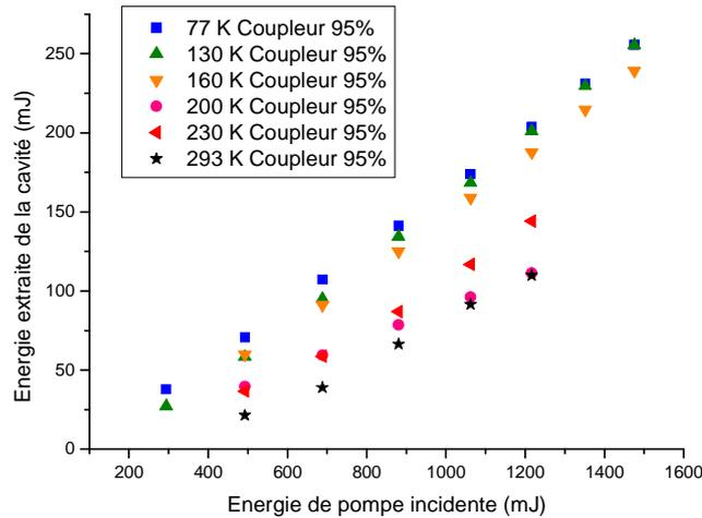
Figure D - 3 : Energies en sortie de l'oscillateur Yb : Lu<sub>2</sub>O<sub>3</sub> dopé 10 at. %, d'épaisseur 1,5 mm en fonction de l'énergie de pompe incidente pour différentes températures du porte échantillon comprises entre 77 K et 293 K.
