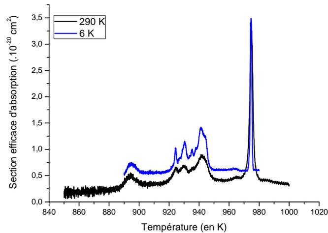
Figure B - 4 : Sections efficaces d'absorption d'une céramique Yb : Sc<sub>2</sub>O<sub>3</sub> dopée 10 at. % à 290 K (courbe noire) et à 6 K (courbe bleue).
