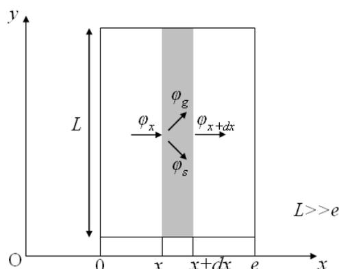
Figure IV - 1 : Bilan thermique d'un système.
