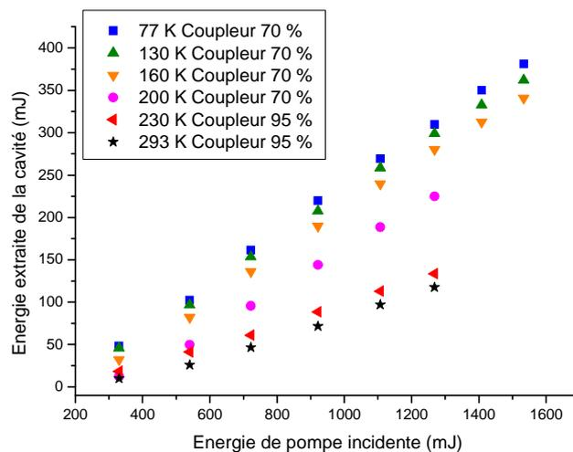
Figure II - 14 : Énergie en sortie d'oscillateur Yb:Lu<sub>2</sub>O<sub>3</sub> d'épaisseur 1,5 mm en fonction de l'énergie de pompe incidente pour différentes températures du porte échantillon comprises entre 77 K et 293 K.
