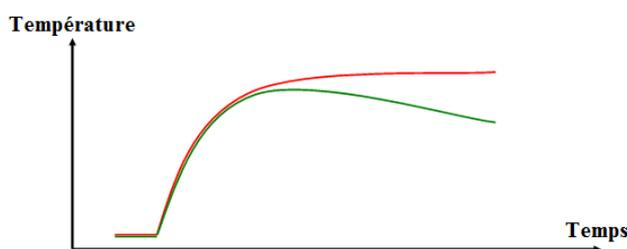
Figure IV - 5 : Influence des pertes thermiques sur l'allure du thermogramme.
