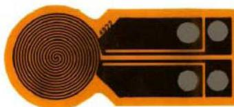
**Figure IV - 10 : Vue d'une sonde « hot disk ».**
