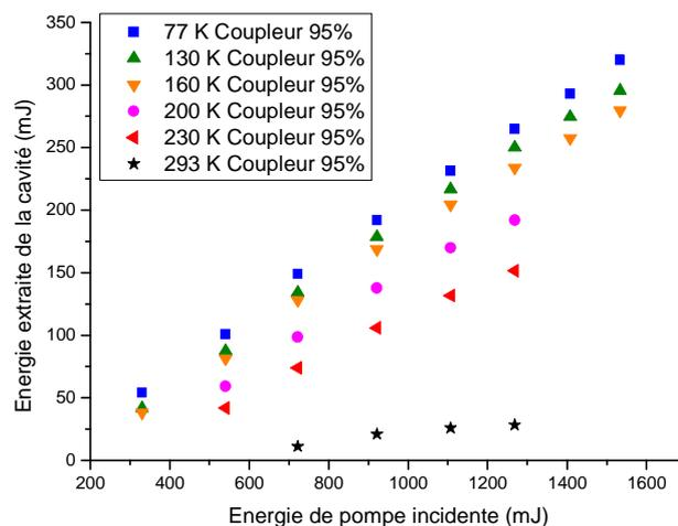
Figure II - 18 : Energie en sortie d'oscillateur Yb : Sc<sub>2</sub>O<sub>3</sub> d'épaisseur 1 mm en fonction de l'énergie de pompe incidente pour différentes températures du porte échantillon comprises entre 77 K et 293 K.
