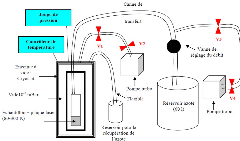
Figure C - 2 : Schéma de principe du cryostat avec son système de vide et son réservoir.
