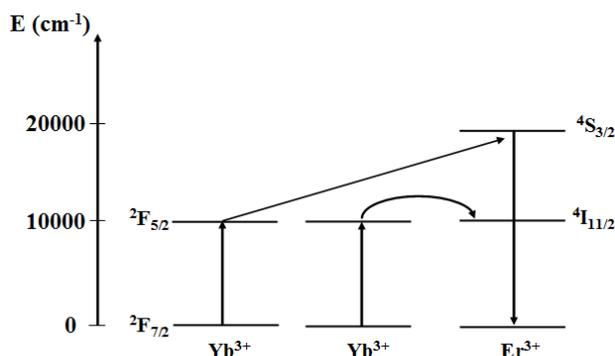
Figure B - 9 : Représentation schématique du processus d'APTE entre deux ions Yb<sup>3+</sup>.
