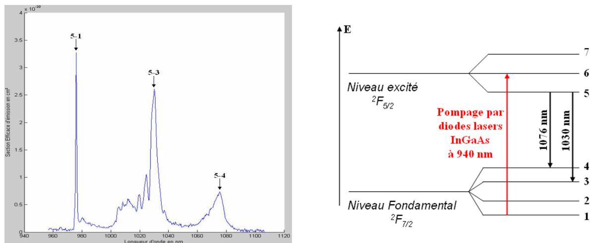
Figure II - 11 : Section efficace d'émission d'une céramique Yb:Y<sub>2</sub>O<sub>3</sub> dopée 10 at. % à 76 K et diagramme énergétique de l'ion Yb<sup>3+</sup>.
