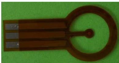
**Figure IV - 18 : Photo de la sonde annulaire.**
