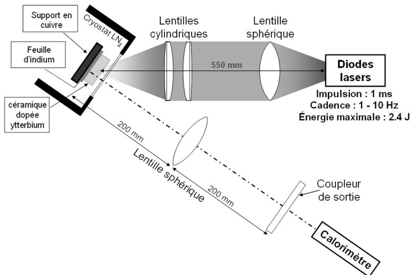
Figure II - 3 : Schéma du dispositif expérimental.
