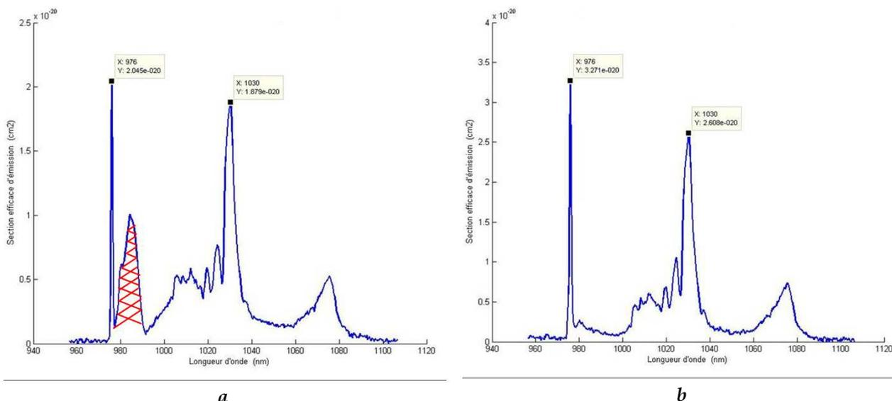
Figure B - 5 : Sections efficaces d'émission de Yb : Y<sub>2</sub>O<sub>3</sub> dopée 10 at. % à 4,2 K (a) et à 76 K (b).
