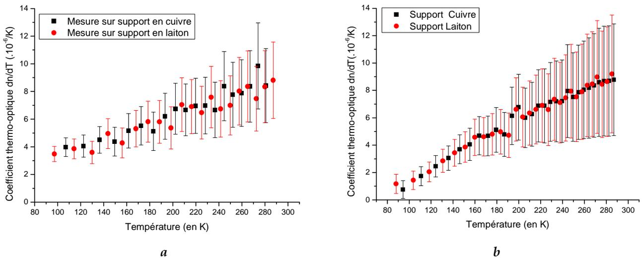
**Figure III - 37 : Coefficients thermo-optiques d'une céramique Yb :Y<sub>2</sub>O<sub>3</sub> dopée 10 at. % (a) et d'une céramique YAG non dopée (b) mesurés sur des supports en laiton et en cuivre.**
