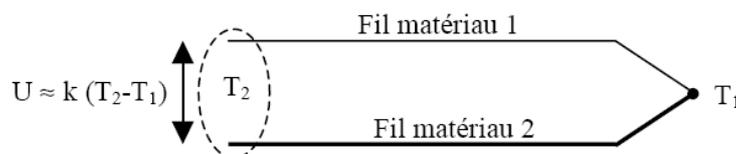
Figure C - 1 : Schéma de principe d'un thermocouple.
