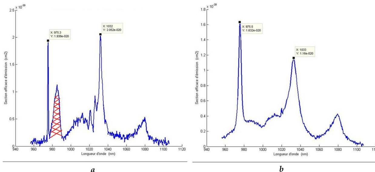
Figure B - 7 : Sections efficaces d'émission de Yb:Lu<sub>2</sub>O<sub>3</sub> dopée 10 at. % à 16 K (a) et à 294 K (b).
