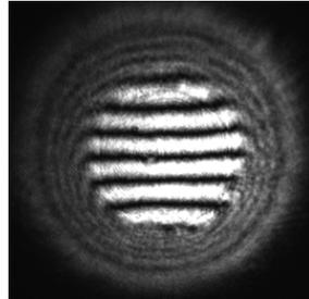
**Figure III - 23 : Photo de la figure d'interférence obtenue en configuration du coin d'air dans le cas d'un échantillon cylindrique.**
