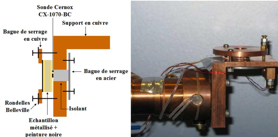
Figure IV - 20 : Schématisation du dispositif mis en place pour maintenir l'échantillon.
