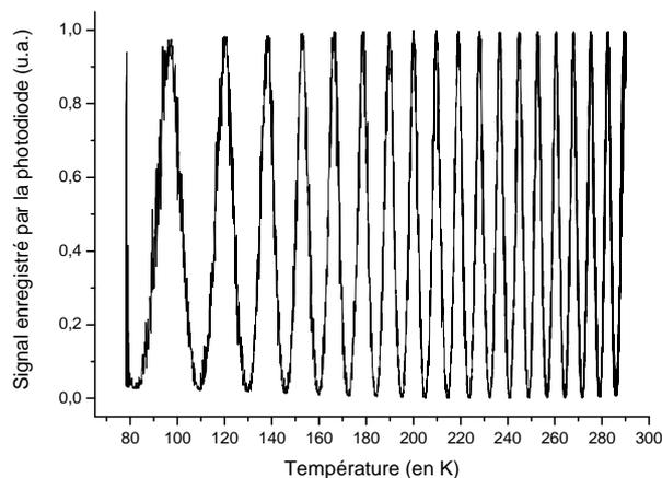
**Figure III - 25 : Enregistrement du signal reçu par la photodiode lors d'une mesure sur un échantillon pour une plage de température allant de la température de l'azote liquide à la température ambiante.**
