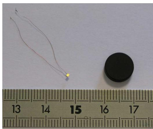
Figure IV - 21 : Photo de la sonde Cernox Cx-1070-BC et d'un cristal Yb:YAG, dopé 1 at. %, de diamètre 10 mm et d'épaisseur 2 mm, dont la face avant métallisée est pulvérisée d'une peinture noire mate.
