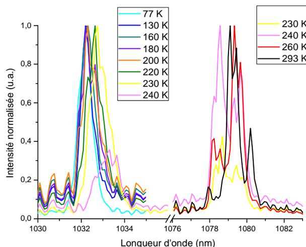
Figure II - 15 : Spectre émis par l'oscillateur laser Yb : Lu<sub>2</sub>O<sub>3</sub> en fonction de la température du porte échantillon.
