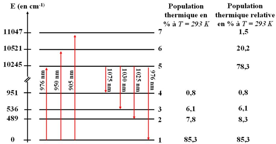
Figure I - 4 : Diagramme énergétique de l'ion ytterbium Yb<sup>3+</sup> dans une matrice Y<sub>2</sub>O<sub>3</sub> (avec un taux de dopage de 10 at. %).
