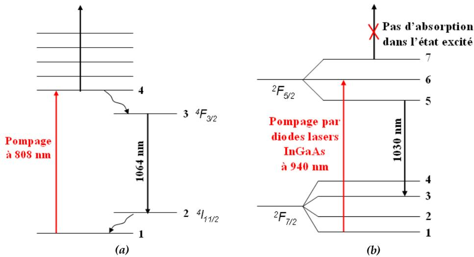
Figure I - 2 : Schéma électronique de l'ion  $Nd^{3+}$  (a) et de l'ion  $Yb^{3+}$  (b) dans une matrice de YAG.
