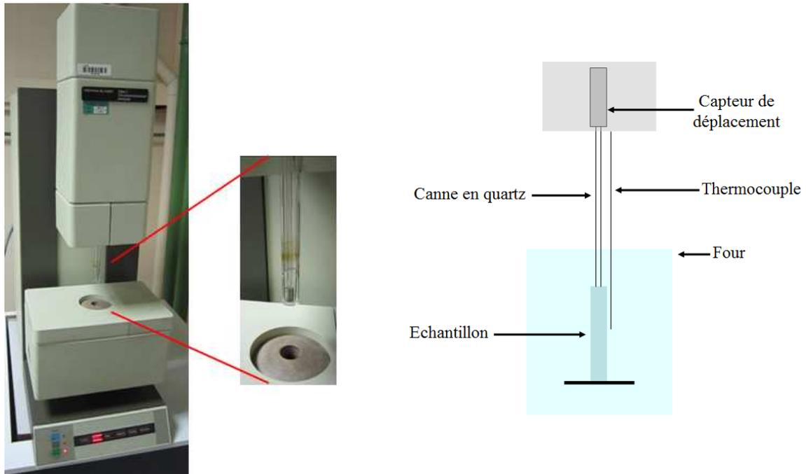
a) Photo du montage expérimental de mesure du coefficient de dilatation à basse température
