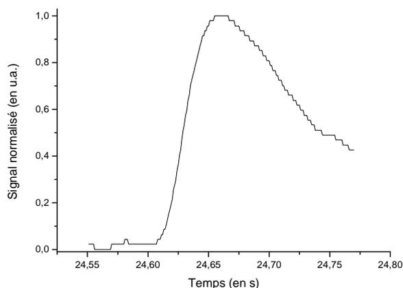
**Figure IV - 25 : Thermogramme obtenu à l'aide d'un thermocouple pour un cristal Yb : YAG dopé 1 at. % à 80 K .**
