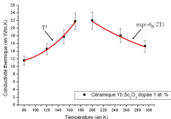
Figure IV - 32 : Modélisation du comportement de la conductivité thermique obtenue pour une céramique Yb :Sc<sub>2</sub>O<sub>3</sub> dopée 1 at. % en fonction de la température.
