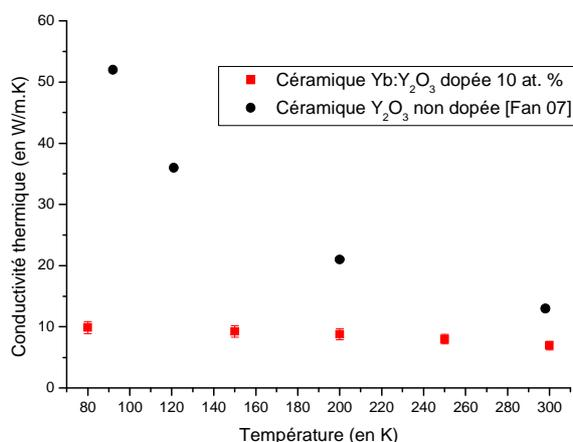
**Figure IV - 29 : Conductivités thermiques obtenues pour une céramique Yb : Y<sub>2</sub>O<sub>3</sub> dopée 10 at. % à basse température. Comparaison avec les conductivités thermiques mesurées sur une céramique Y<sub>2</sub>O<sub>3</sub> non dopée [Fan 07].**
