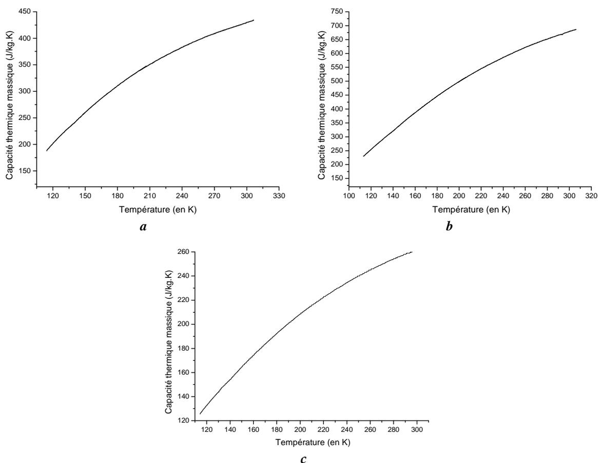
**Figure IV - 19 : Capacités thermiques massiques de céramiques Yb :Y<sub>2</sub>O<sub>3</sub> dopée 10 at. % (a), Yb :Sc<sub>2</sub>O<sub>3</sub> dopée 1 at. % (b) et Yb :Lu<sub>2</sub>O<sub>3</sub> dopée 1 at. % (c) à basse température.**
