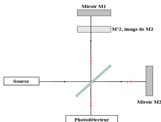
Figure III - 1 : Schéma de l'interféromètre de Michelson.
