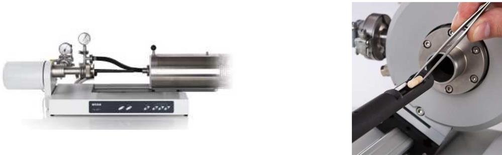
Figure III - 2 : Photos d'un dilatomètre NETZSCH, modèle DIL 402 C, et de son support échantillon.
