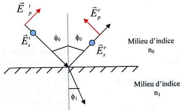
Figure III - 6 : Représentation du champ électrique lors d'une réflexion sur une surface plane.
