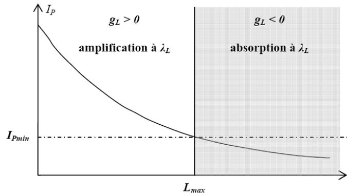
Figure I - 5 : Longueur d'amplification limitée dans le cas d'un laser quasi-3 niveaux.
