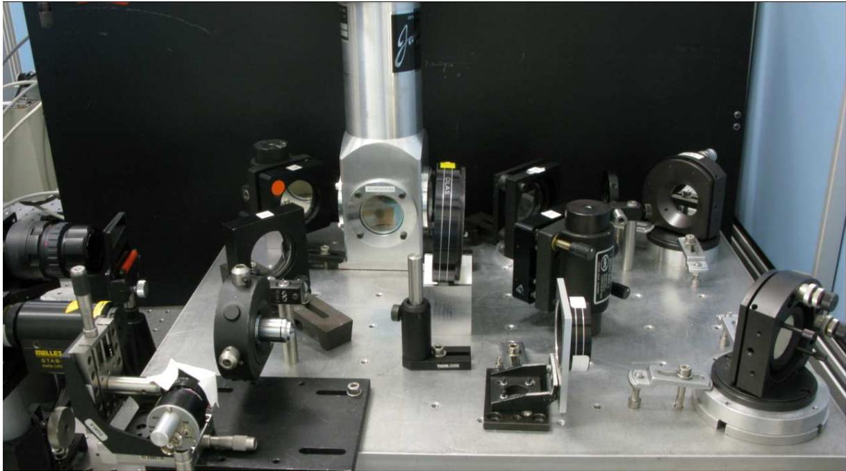
Figure III - 21 : Photo de l'interféromètre type Mach-Zehnder.
