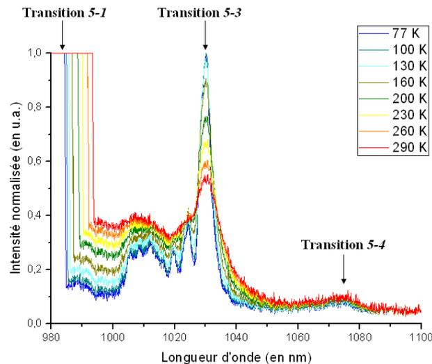
Figure II - 8 : Spectre de fluorescence de la céramique Yb : Y<sub>2</sub>O<sub>3</sub> dopée 10 at. % en fonction de la température du support échantillon.
