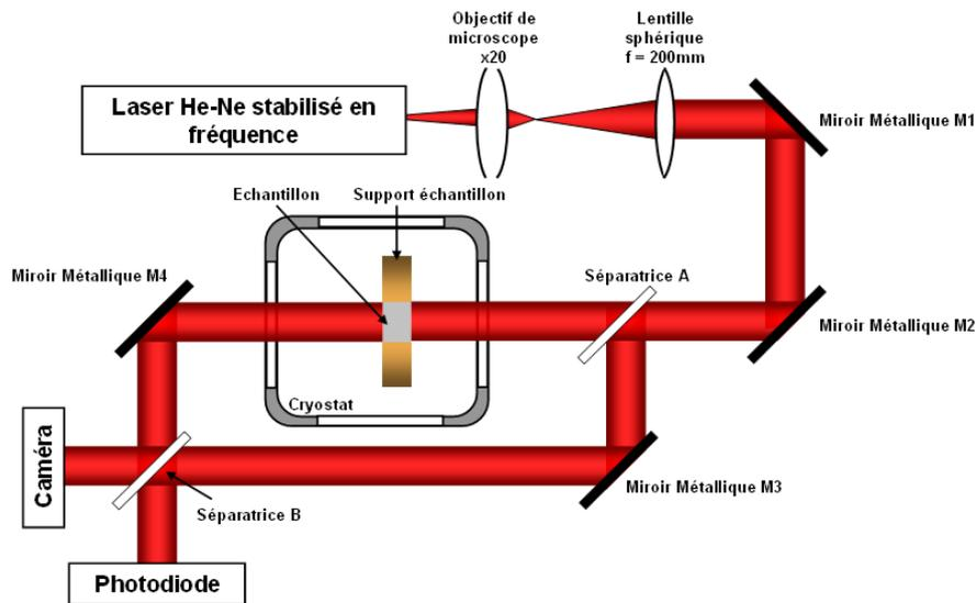
Figure III - 20 : Schéma de l'interféromètre type Mach-Zehnder.
