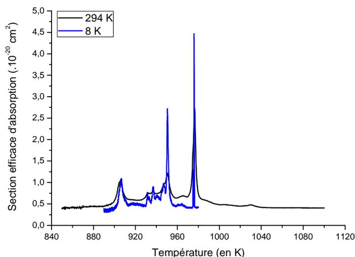
Figure B - 2 : Sections efficaces d'absorption d'une céramique Yb :  $Y_2O_3$  dopée 10 at. % à 294 K (courbe noire) et à 8 K (courbe bleue).
