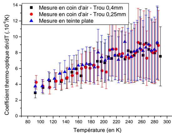
Figure III - 39 : Comparaison des calculs de coefficients thermo-optiques d'une céramique Yb : Y<sub>2</sub>O<sub>3</sub> dopée 10 at. % sur des mesures réalisées en configuration de teinte plate ou de coin d'air.
