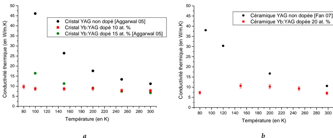
**Figure IV - 28 : *a* : Conductivités thermiques obtenues pour un cristal Yb : YAG dopé 10 at. % à basse température. *b* : Conductivités thermiques obtenues pour une céramique Yb : YAG dopée 20 at. % à basse température. Comparaison avec les conductivités thermiques mesurées sur des cristaux / céramiques YAG [Aggarwal 05], [Fan 07].**
