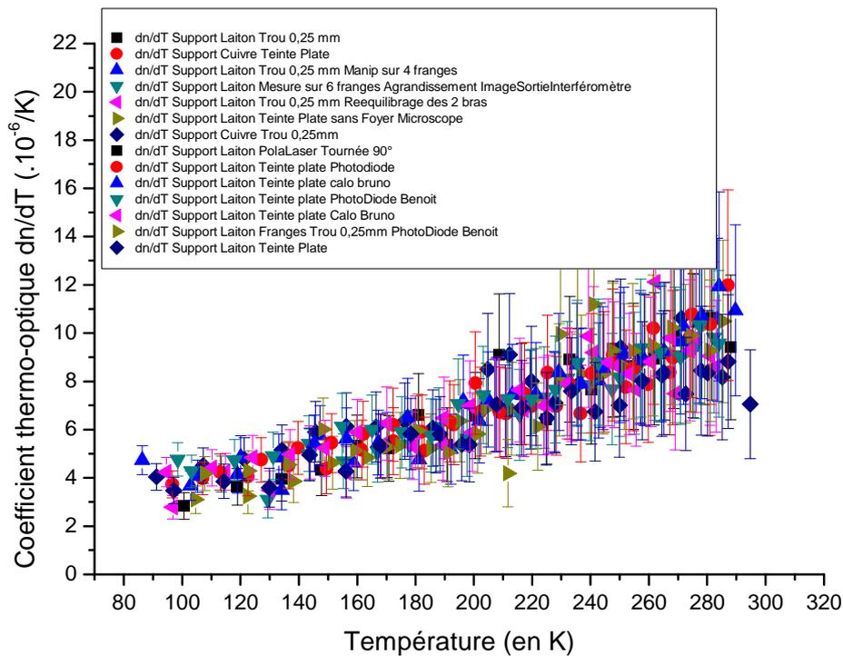
Figure III - 43 : 14 mesures différentes de coefficients thermo-optiques d'une céramique Yb :Y<sub>2</sub>O<sub>3</sub> dopée 10 at. %.
