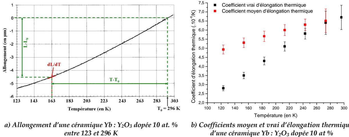
a) Allongement d'une céramique Yb : Y<sub>2</sub>O<sub>3</sub> dopée 10 at. % entre 123 et 296 K
