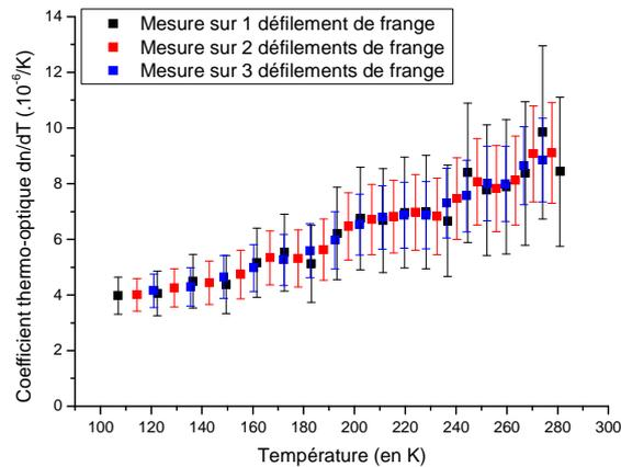
Figure III - 38 : Comparaison des calculs de coefficients thermo-optiques d'une céramique Yb : Y<sub>2</sub>O<sub>3</sub> dopée 10 at. % considérant 1, 2 ou 3 défilements de franges.
