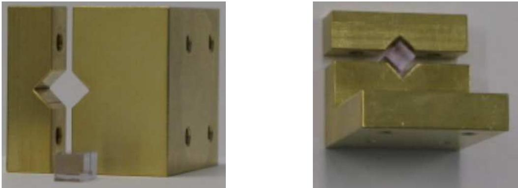
Figure III - 22 : Photo du support échantillon en laiton avec un échantillon de verre phosphate dopé néodyme.
