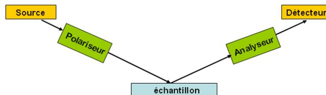
Figure III - 7 : Principe de base de l'ellipsométrie.
