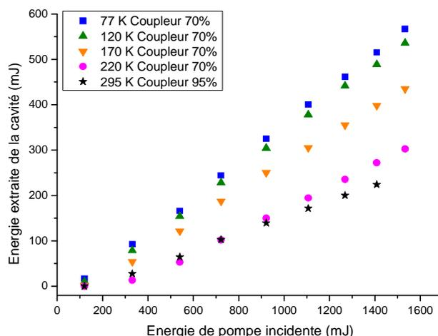
Figure II - 9 : Energie en sortie d'oscillateur Yb :Y<sub>2</sub>O<sub>3</sub> d'épaisseur 2 mm en fonction de l'énergie de pompe incidente pour différentes températures du porte échantillon comprises entre 77 K et 293 K.
