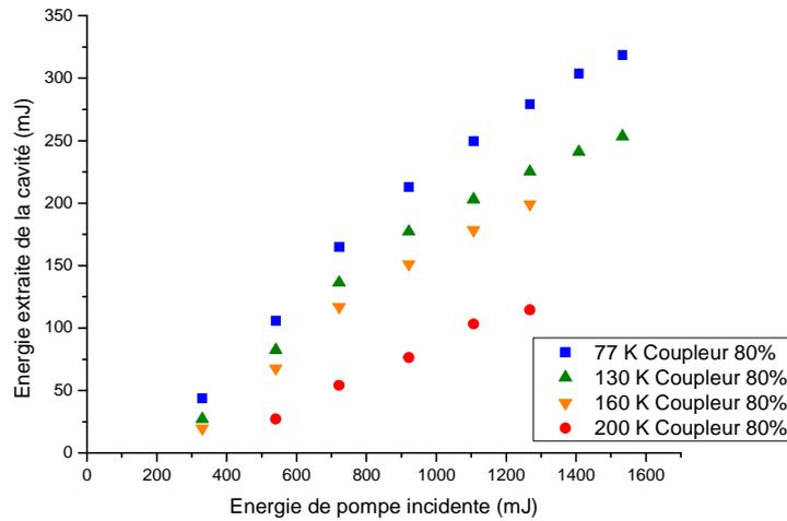
Figure D - 4 : Energies en sortie d'oscillateur Yb : Sc<sub>2</sub>O<sub>3</sub> dopé 10 at. %, d'épaisseur 1 mm en fonction de l'énergie de pompe incidente pour des températures du porte échantillon comprises entre 77 K et 200 K.
