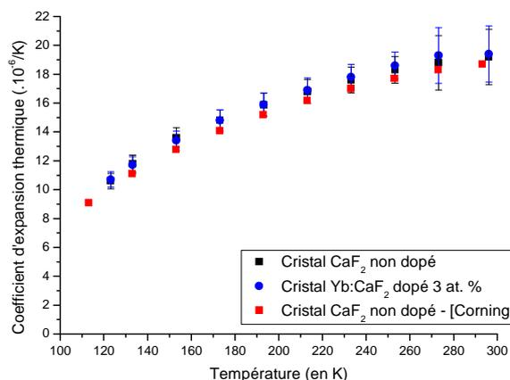
Figure III - 18 : Coefficients d'élongation thermique de cristaux de  $CaF_2$  non dopé et dopé à basse température. Comparaison avec les valeurs de dilatation données par Corning.
