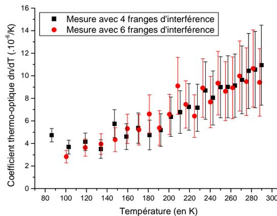
Figure III - 40 : Comparaison des calculs de coefficients thermo-optiques d'une céramique Yb :Y<sub>2</sub>O<sub>3</sub> dopée 10 at. % sur des mesures réalisées en configuration de coin d'air pour 4 ou 6 franges d'interférence.
