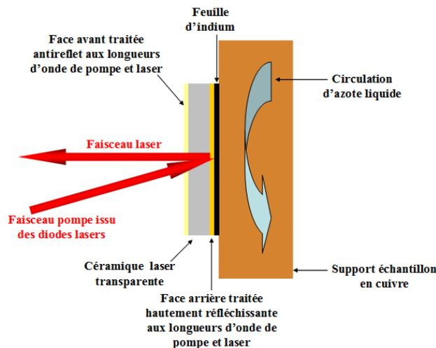
Figure II - 4 : Zoom sur l'échantillon : systèmes de pompage et de refroidissement du disque laser.
