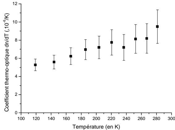
Figure III - 27 : Coefficient thermo-optique d'une céramique Yb :Lu<sub>2</sub>O<sub>3</sub> dopée 1 at. %, diamètre 4 mm et épaisseur 3 mm, d'indice de réfraction de 1,85 à la longueur d'onde de 632,8 nm.
