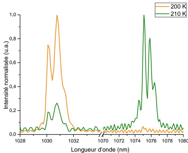
Figure II - 12 : Spectre émis par l'oscillateur laser  $\text{Yb}:\text{Y}_2\text{O}_3$  à 200 K et 210 K.
