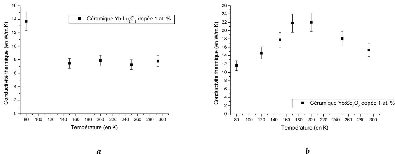
Figure IV - 30 : *a* : Conductivités thermiques obtenues pour une céramique Yb :  $\text{Lu}_2\text{O}_3$  dopée 1 at. % à basse température. *b* : Conductivités thermiques obtenues pour une céramique Yb :  $\text{Sc}_2\text{O}_3$  dopée 1 at. % à basse température.
