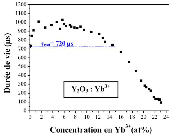
Figure B - 10 : Mesures des durées de vie radiative de cristaux  $\text{Yb} : \text{Y}_2\text{O}_3$  pour différents taux de dopage.
