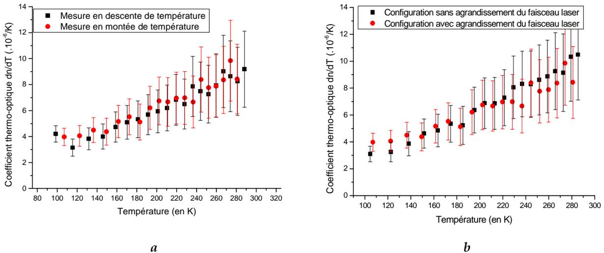
Figure III - 41 : Comparaison des calculs de coefficients thermo-optiques d'une céramique Yb :Y<sub>2</sub>O<sub>3</sub> dopée 10 at. % entre une montée et une descente de température (a) et en considérant ou non un faisceau laser He-Ne agrandi (b).
