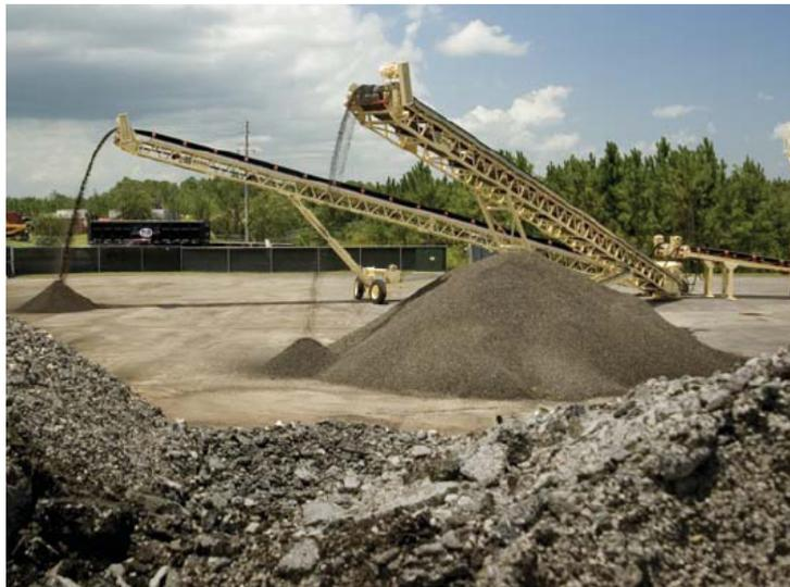
*Fig. I-13 : fractionnement des agrégats d'enrobé
