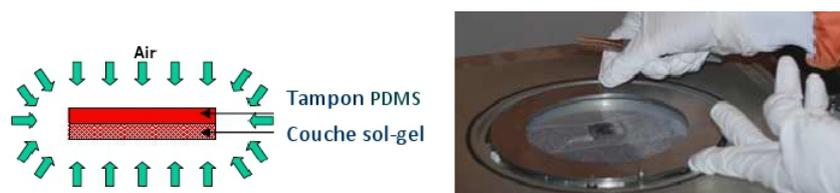
FIGURE 2.12 – Pression uniforme appliquée par deux membranes lors de la phase d'impression. La photographie représente l'insertion dans la machine d'imprint de l'échantillon et du moule (carré sombre), intercalés au préalable entre 2 membranes en forme de disque.
