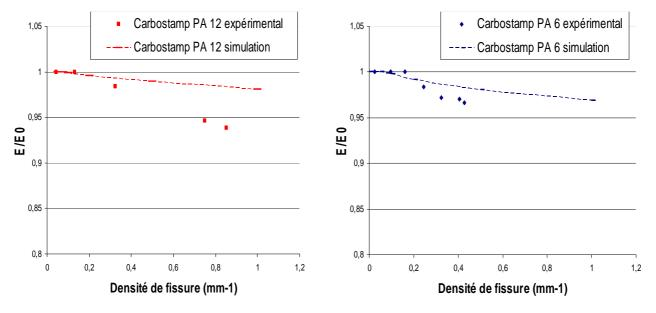
Figure 84 : Comparaison des évolutions de rigidités expérimentales et numériques pour le Carbostamp<sup>TM</sup> PA 12 (courbes de gauche) et le Carbostamp<sup>TM</sup> PA 6 (courbes de droite)
