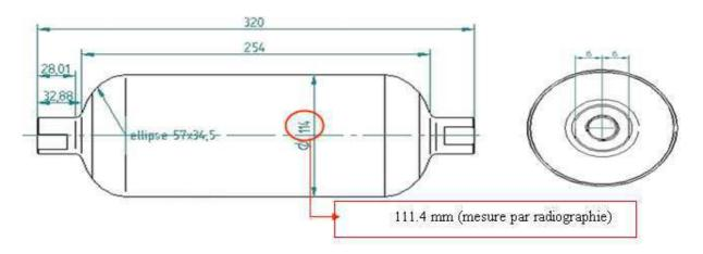
Figure 124 : Caractéristiques géométriques de l'assemblage embase-liner
