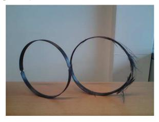
Figure 110 : Localisation de la rupture avec l'insertion d'entailles
