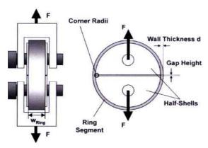
Figure 109 : Dispositif de traction sur anneau composite suivant la norme ASTM D 2290 (Henninger<sup>[82, 83]</sup>)
