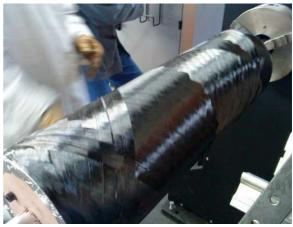
Figure 106 : Essais de trajectoires circonférentielle (à gauche) et hélicoïdale (à droite)
