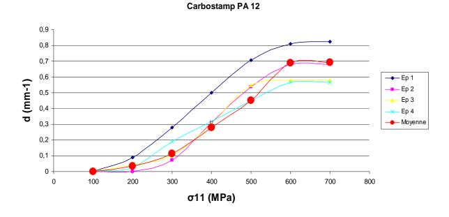
Figure 70 : Courbes expérimentales d'évolution de la densité de fissures, d, au cours du chargement imposé pour un stratifié [0°2, 90°2]s de Carbostamp<sup>TM</sup> PA 12
