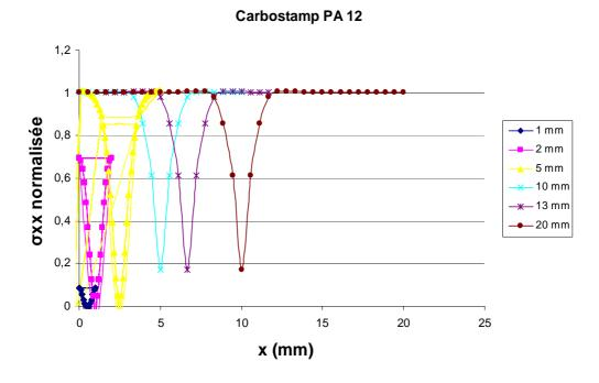
Figure 78 : Evolution de la contrainte dans le pli à 90° pour différentes longueurs de VER, cas du Carbostamp<sup>TM</sup> PA 12
