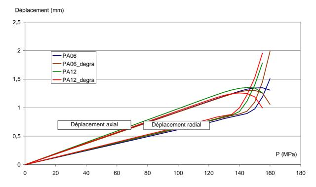
Figure 134 : Influence de la fissuration dans les plis à 90°, ±62° et ±56° sur l'évolution des déformations radiales et axiales du réservoir en fonction de la pression appliquée
