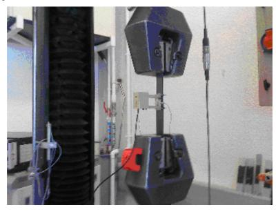
Figure 67 : Vue générale du dispositif expérimental de traction avec positionnement de l'extensomètre
