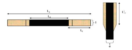
Figure 50 : Géométrie des éprouvettes
