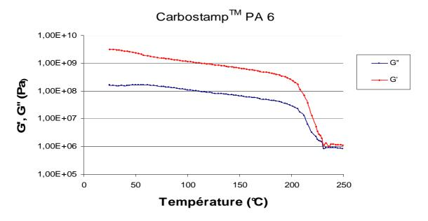
Figure 65 : Evolution des modules de conservation et de perte lors d'un balayage en température pour le Carbostamp<sup>TM</sup> PA 6
