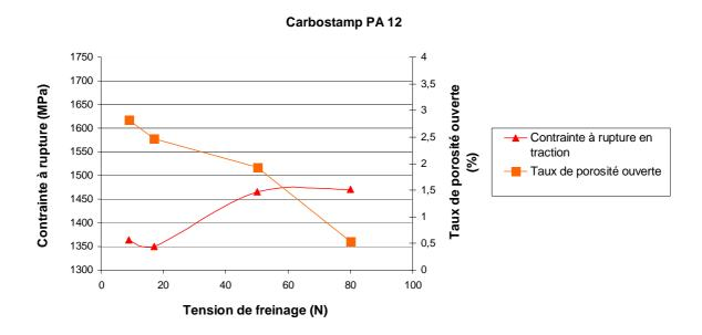
Figure 113 : Evolution des propriétés mécaniques et du taux de porosité ouverte du Carbostamp<sup>TM</sup>
