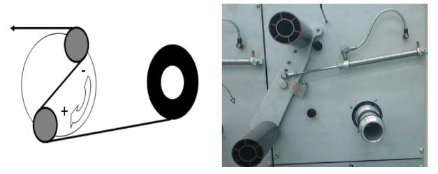
Figure 101 : Schéma et photo d'un dispositif de compensateur de tension
