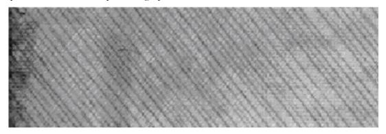
Figure 20 : Mise en évidence de fissures par radiographie X de stratifiés composites [87]
