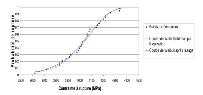
Figure 95 : Evolution de la probabilité à rupture de mèche de fibres de Carbone de type T700<sup>TM</sup> en fonction de la contrainte appliquée (loi statistique de type Weibull)
