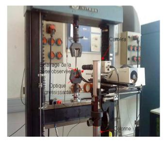
Figure 68 : Schéma et photographie du montage pour l'observation des fissures intralaminaires sur une séquence de [0°2, 90°2]<sub>s</sub>
