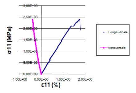
Figure 54 : Essais de traction sur séquence [0°]4 avec mesure des déformations longitudinale et transverse (exemple d'une éprouvette de Carbostamp<sup>TM</sup> PA 6)
