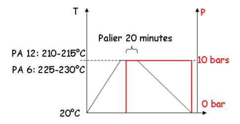
Figure 48 : Cycle en température et pression pour la mise en œuvre des échantillons par thermocompression
