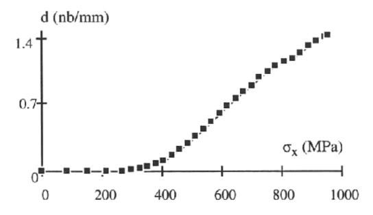
Figure 29 : Evolution de la densité de fissure au sein du pli à 90° d'un stratifé carbone/epoxy de séquence (0°,90°) en fonction de la contrainte de traction monotone [108]
