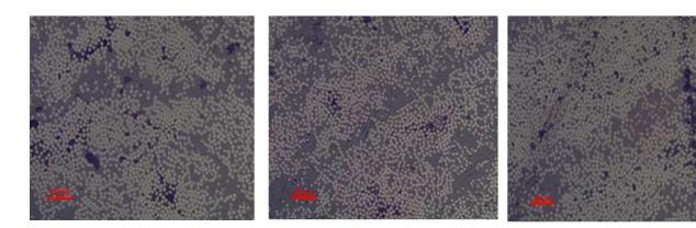
Figure 118 : Suivi des porosités par microscopie pour différentes valeurs de pression de consolidation - 2.5 bars (à gauche), 5 bars (au centre) et 7 bars (à droite)
