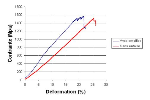
Figure 111 : Influence de l'insertion d'entailles sur la courbe contrainte-déformation d'un essai de traction sur anneau (Cas du Carbostamp<sup>TM</sup> PA 12)
