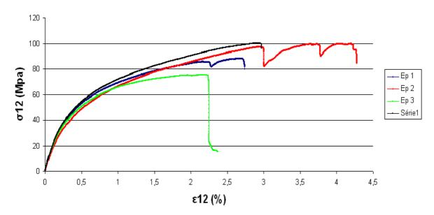
Figure 59 : Courbes d'essais de traction à rupture sur des séquences [±45°]<sub>s</sub> de Carbostamp™ PA 12 (Cellule de force 250 kN, vitesse de déformation 1 mm/min, suivi de l'allongement par extensomètre numérique de longueur de jauge 50 mm puis par déplacement de la traverse)
