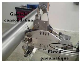
Figure 104 : Système de consolidation de la nappe sur le mandrin
