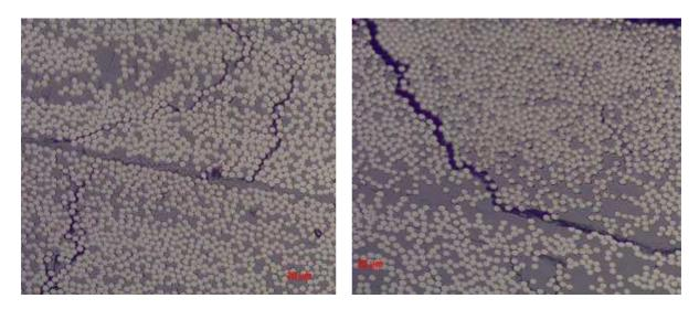
Figure 86 : Endommagements apparaissant dans une séquence [±45°]<sub>s</sub>, fissures transverses localisées dans les plis (x20, photo de gauche), délaminage en pointe de fissure (x20, photo de droite)
