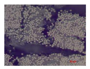
Figure 88 : Coalescence des défauts à l'origine de la rupture d'une séquence [±45°]
