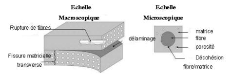
Figure 19: Principaux endommagements rencontrés dans un matériau composite [85]
