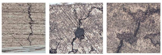
Figure 69 : Orientation d'une fissure dans les plis à 90° sans obstacle (x10, photo de gauche), en présence d'une porosité (x10 photo du centre), en présence d'une zone pauvre en matrice (x10, photo de droite)
