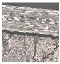
Figure 72 : Développement des endommagements lors d'un chargement/déchargement répété progressif d'une séquence  $[0^{\circ}_{2}, 90^{\circ}_{2}]_{s}$ -apparition de fissures transverses (150 MPa <  $\sigma$  <600 MPa), apparition de fissures longitudinales et de délaminage ( $\sigma$  > 700 MPa)
