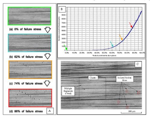
Figure 32 : Illustration de l'endommagement par rupture de fibres de la séquence [05] [8],
