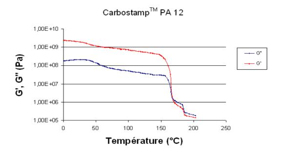
Figure 64 : Evolution des modules de conservation et de perte lors d'un balayage en température pour le Carbostamp<sup>TM</sup> PA 12
