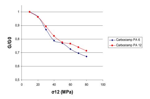
Figure 89 : Evolution de rigidité  $G/G_0$  de stratifié  $[\pm 45^\circ]_s$  de Carbostamp<sup>TM</sup> PA 12 et Carbostamp<sup>TM</sup> PA 6 en fonction de la contrainte imposée (vitesse de chargement 1 MPa/s, temps de relaxation 30 minutes)
