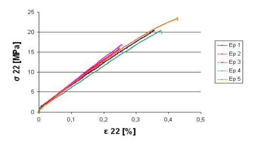
Figure 56 : Courbes d'essais de traction à rupture sur séquence [90°]<sub>8</sub> pour le Carbostamp<sup>TM</sup> PA 6 (Cellule de force 250 kN, vitesse de déformation 1 mm/min, suivi de l'allongement par extensomètre numérique de longueur de jauge 50 mm puis par déplacement de la traverse)
