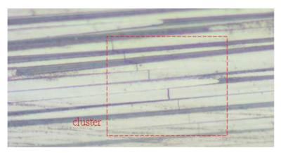
Figure 100 : Visualisation d'un cluster de fibres rompues sur une éprouvette de Carbostamp<sup>TM</sup> PA 6 soumise à un chargement de 2000 MPa
