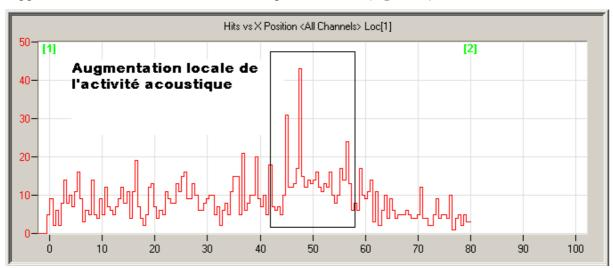
Figure 98 : Localisation des coups sur une éprouvette de Carbostamp<sup>TM</sup> PA6 unidirectionnelle soumise à un chargement monotone en traction longitudinale-mise en évidence d'une zone de forte activité acoustique
