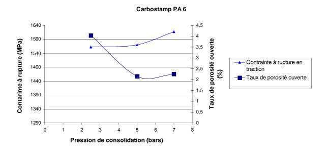
Figure 117: Evolution de la contrainte à rupture en traction et du taux de porosité ouverte en fonction de la pression de consolidation d'anneaux composites Carbostamp<sup>TM</sup> PA 6
