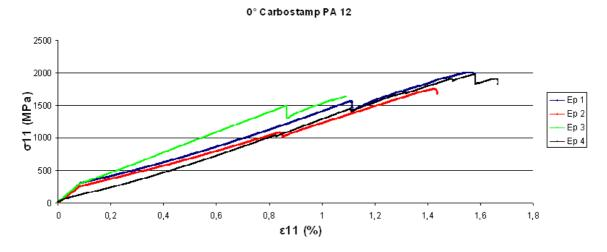
Figure 51 : Courbe d'essais de traction à rupture sur séquences [0°]4 pour le Carbostamp<sup>TM</sup> PA 12 (Cellule de force 250 kN, vitesse de déformation 2 mm/min, suivi de l'allongement par extensomètre numérique de longueur de jauge 50 mm puis par déplacement de la traverse)
