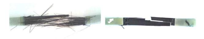
Figure 53 : Différents types de ruptures rencontrées pour les séquences [0°]<sub>4</sub> ;
