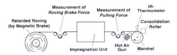
Figure 16 : Enroulement filamentaire de composites fibres de carbone/matrice polyamide avec imprégnation en ligne [83]
