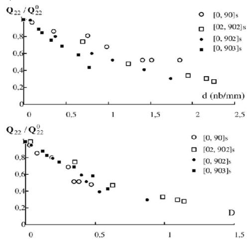
Figure 30 : Chute de rigidité transversale de stratifiés de séquences  $[0_n, 90_m]_s$  en fonction de la densité de fissure et de alpha (noté D ici) [105]
