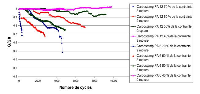
Figure 94 : Evolution des modules de cisaillement lors d'essais de fatigue sur stratifiés  $[\pm 45^{\circ}]_s$  de Carbostamp<sup>TM</sup> PA 12 et Carbostamp<sup>TM</sup> PA 6
