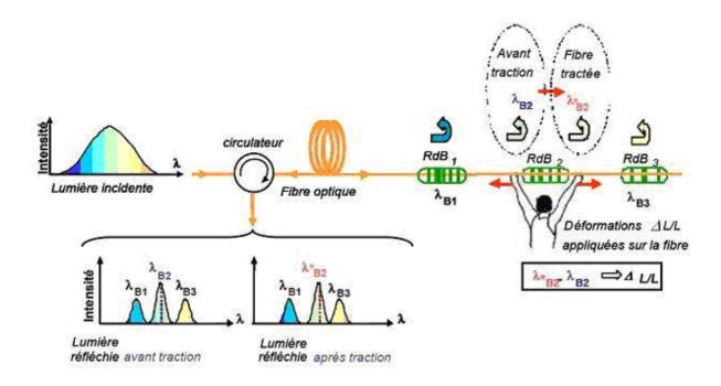
Figure 26 : Principe de la mesure de paramètres à l'aide de réseaux de Bragg [99]
