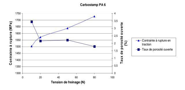
Figure 114 : Evolution des propriétés mécaniques et du taux de porosité ouverte du Carbostamp<sup>TM</sup>
