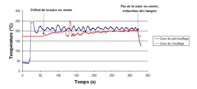
Figure 108 : Mesure des températures des zones de préchauffage et de chauffage de la nappe lors de la fabrication d'un anneau de Carbostamp<sup>TM</sup> PA 12
