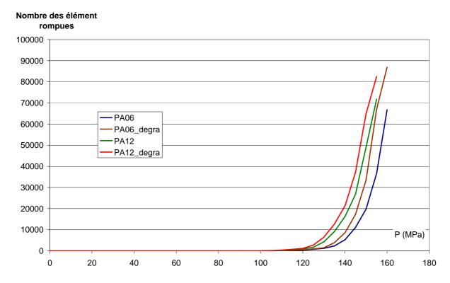
Figure 133 : Influence de la fissuration dans les plis à 90°, ±62° et ±56° sur le nombre d'éléments finis rompus en fonction de la pression appliquée
