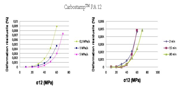
Figure 92 : Influence de la vitesse de sollicitation (graphique de gauche) et du temps de relaxation à contrainte nulle (graphique de droite) sur l'évolution de la déformation résiduelle en fonction du chargement imposé pour le Carbostamp<sup>TM</sup> PA 12
