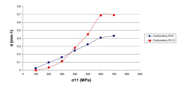
Figure 73 : Comparaison des courbes d'évolution de la densité de fissure au cours du chargement imposé du Carbostamp<sup>TM</sup> PA 12 et du Carbostamp<sup>TM</sup> PA 6
