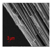
Figure 58 : Observation au microscope à balayage électronique du faciès de rupture d'une séquence [90°]<sub>8</sub> de Carbostamp<sup>TM</sup> PA 12 (photo de gauche) et de Carbostamp<sup>TM</sup> PA 6 photo de droite)
