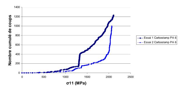
Figure 97 : Evolution de l'émission acoustique d'un stratifié unidirectionnel Carbostamp<sup>TM</sup> PA 6 sous traction longitudinale
