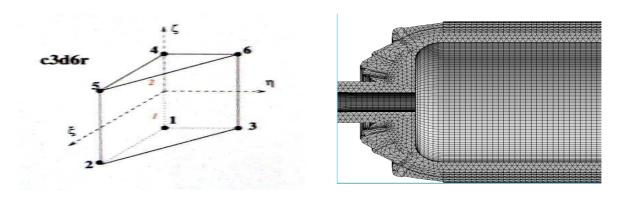
Figure 127 : Eléments finis utilisés (photo de gauche) et maillage du réservoir (photo de droite)
