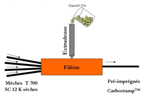
Figure 36 : Technique d'imprégnation des fibres de carbone dédiée à la fabrication des pré-imprégnés
