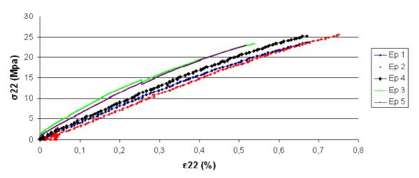
Figure 55 : Courbes d'essais de traction à rupture sur séquences [90°]<sub>8</sub> pour le Carbostamp™ PA 12 (Cellule de force 250 kN, vitesse de déformation 1 mm/min, suivi de l'allongement par extensomètre numérique de longueur de jauge 50 mm puis par déplacement de la traverse)
