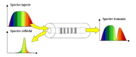
Figure 25 : Fonctionnement d'un réseau de Bragg [99]
