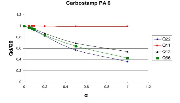
Figure 122 : Chutes des rigidités du pli à 90° pour le matériau homogène équivalent, cas du  ${\rm Carbostamp^{TM}~PA~6}$
