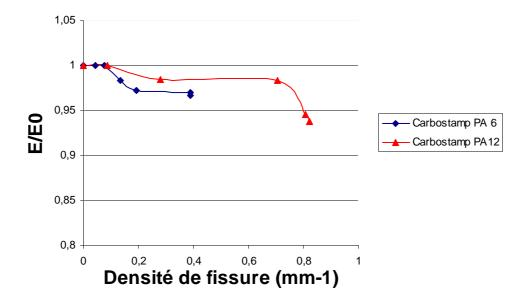
Figure 82 : Evolution de rigidité  $E/E_0$  de stratifiés  $[0^{\circ}_2, 90^{\circ}_2]_s$  de Carbostamp<sup>TM</sup> PA 12 et Carbostamp<sup>TM</sup> PA 6 en fonction de la densité de fissures d
