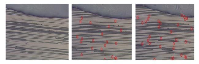
Figure 99 : Accumulation des ruptures de fibres (entourées en rouge) dans un stratifié unidirectionnel Carbostamp™ PA 12 soumis à un chargement monotone-à 0 MPA (photo de gauche), 1600 MPa (photo du centre) et 2000 MPa (photo de droite)
