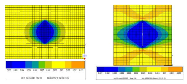
Figure 85 : Mise en évidence de l'hétérogénéité de la déformation aux limites du VER pour le Carbostamp<sup>TM</sup> PA 12 ; élément L= 5 mm (photo de gauche) et élément L= 2mm (photo de droite)
