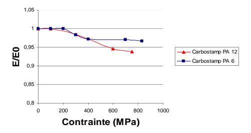
Figure 81 : Evolution de rigidité E/E<sub>0</sub> de stratifiés [0°<sub>2</sub>, 90°<sub>2</sub>]<sub>s</sub> de Carbostamp<sup>TM</sup> PA 12 et Carbostamp<sup>TM</sup> PA 6 en fonction de la contrainte appliquée
