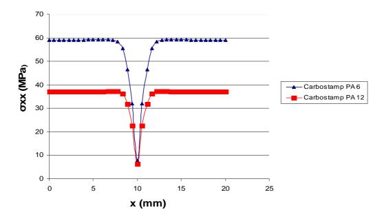
Figure 76 : Evolution de la contrainte théorique suivant l'axe x dans les plis à 90° pour le Carbostamp<sup>TM</sup> PA 12 et PA 6
