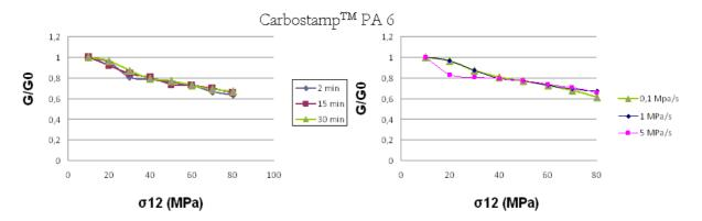
Figure 91 : Influence du temps de relaxation à contrainte nulle (graphique de gauche) et de la vitesse de chargement (graphique de droite) sur l'évolution du module de cisaillement en fonction du chargement imposé pour le Carbostamp<sup>TM</sup> PA 6
