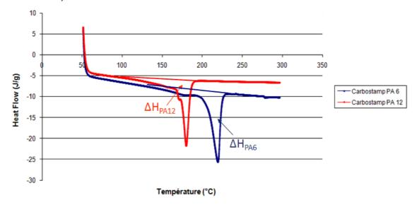
Figure 41 : Détermination des températures de fusion et taux de cristallinité par DSC (rampe de 50 à 300°C à 10°C/min)
