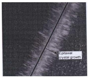
Figure 8 : Mise en évidence de la zone transcristalline dans un composite fibre de carbone/matrice polypropylène  $^{[30]}$
