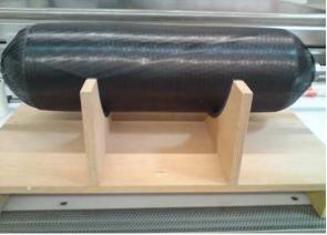
Figure 107 : Objets mis en œuvre par enroulement filamentaire-tubes réalisés sur mandrin métalliques (à gauche) et réservoirs (à droite)
