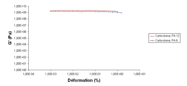
Figure 63 : Evolution des modules d'élasticité des matériaux d'étude (essais de torsion en rhéologie dynamique, f=1 rad/s, T=25°C, balayage en déformation de 0,001 à 2%)
