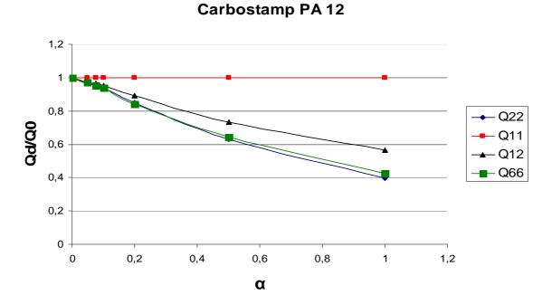
Figure 121 : Chutes des rigidités du pli à 90° pour le matériau homogène équivalent, cas du Carbostamp<sup>TM</sup> PA 12
