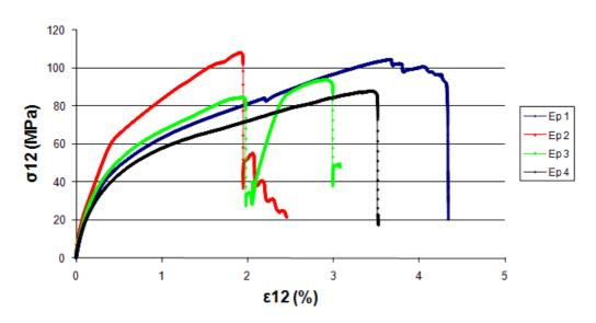
Figure 60 : Courbes des essais des traction à rupture sur séquences [±45°]<sub>s</sub> de Carbostamp<sup>TM</sup> PA 6 (Cellule de force 250 kN, vitesse de déformation 1 mm/min, suivi de l'allongement par extensomètre numérique de longueur de jauge 50 mm puis par déplacement de la traverse)
