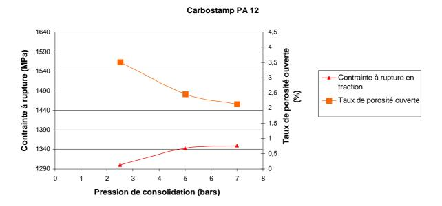
Figure 116 : Evolution des propriétés mécaniques et du taux de porosité ouverte du Carbostamp<sup>TM</sup>
