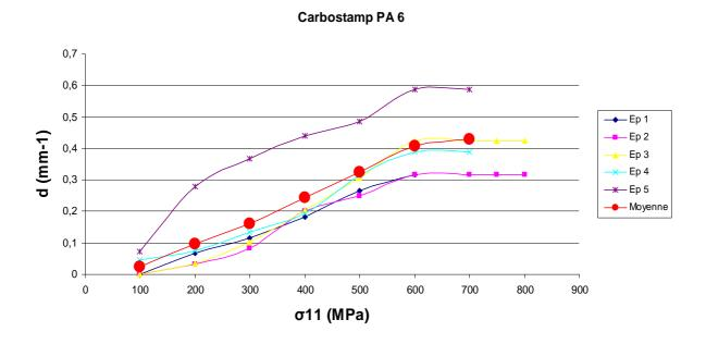
Figure 71 : Courbes expérimentales de l'évolution de la densité de fissures d au cours du chargement imposé pour un stratifié [0°2, 90°2]<sub>s</sub> de Carbostamp<sup>TM</sup> PA 6
