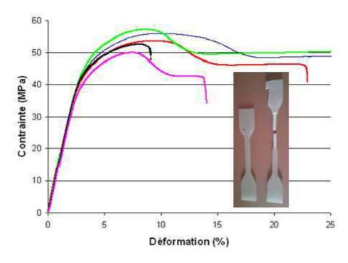
Figure 43 : Courbes de traction sur éprouvettes PA 12
