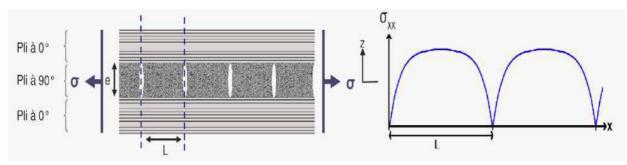
Figure 74 : Schéma de tracé de la courbe de contrainte de traction théorique le long de l'axe x, au niveau du pli à 90°; zones de transfert de charges
