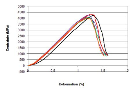
Figure 39 : Courbes contrainte-déformation obtenues avec les rubans de fibres de carbone
