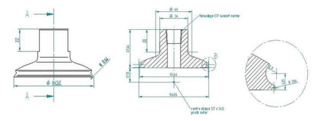
Figure 123 : Caractéristiques géométriques de l'embase
