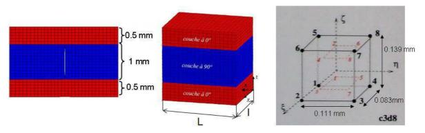
Figure 75 : Description du Volume élémentaire représentatif du matériau endommagé et des dimensions de l'élément fini utilisé
