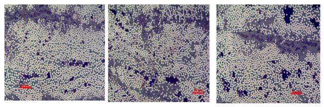
Figure 120 : Suivi des porosités par microscopie pour différentes valeurs de vitesse de mise en oeuvre - 2 m/min (à gauche), 6 m/min (au centre) et 10 m/min (à droite)
