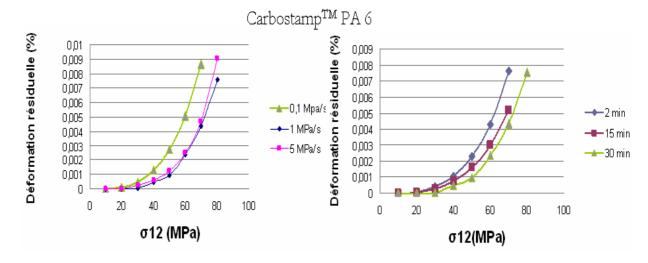
Figure 93 : Influence de la vitesse de sollicitation (graphique de gauche) et du temps de relaxation à contrainte nulle (graphique de droite) sur l'évolution de la déformation résiduelle en fonction du chargement imposé pour le Carbostamp<sup>TM</sup> PA 6
