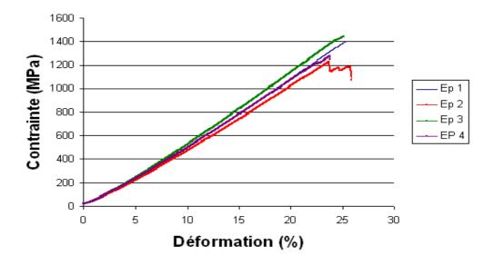
Figure 112 : Courbes des essais de traction sur anneaux composites en Carbostamp™ PA 12 (fabrication avec le jeu de paramètres standard)
