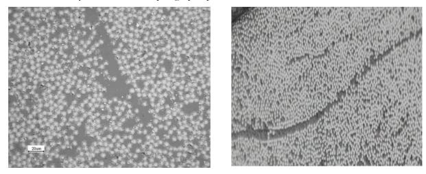
Figure 49 : Observations en microscopie optique de la section polie des matériaux aprés élaboration : Carbostamp<sup>TM</sup> PA 12 à gauche (x50) Carbostamp<sup>TM</sup> PA 6 à droite (x20)
