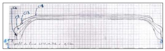
Figure 126 : Relevé des épaisseurs et des diamètres d'ouverture des plis hélicoïdaux au niveau des dômes
