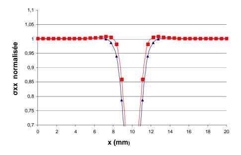
Figure 77 : Evolution de la contrainte théorique normalisée suivant l'axe x dans les plis à 90° pour le  $Carbostamp^{TM}\ PA\ 12\ et\ PA\ 6$
