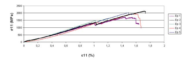
Figure 52 : Courbe d'essais de traction à rupture sur séquences [0°]<sub>4</sub> pour le Carbostamp<sup>TM</sup> PA 6 (Cellule de force 250 kN, vitesse de déformation 2 mm/min, suivi de l'allongement par extensomètre numérique de longueur de jauge 50 mm puis par déplacement de la traverse)
