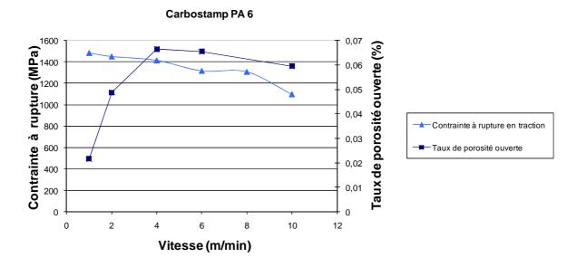
Figure 119 : Evolution de la contrainte à rupture et du taux de porosité ouverte d'anneaux en Carbostamp<sup>TM</sup> PA6 en fonction de la vitesse d'enroulement
