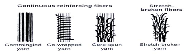
Figure 9 : Différentes architectures de commélés fibres de carbone/fibres de polyamide [50]
