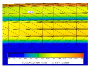
Figure 130 : Observation des contraintes locales suivant la direction des fibres dans les différents plis de la partie cylindrique
