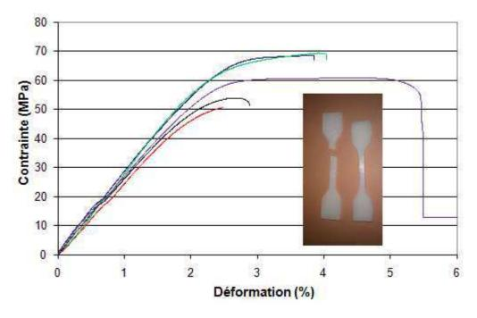
Figure 44 : Courbes de traction sur éprouvettes PA 6
