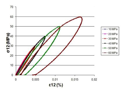
Figure 62 : Chargement répétitif progressif d'une éprouvette [±45°]<sub>s</sub> (exemple d'une éprouvette de Carbostamp<sup>TM</sup> PA 12)
