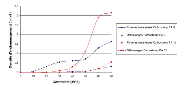
Figure 87 : Courbes expérimentales de densités de fissures transverses et de délaminages au cours du chargement imposé pour les séquences [±45°]<sub>s</sub> de Carbostamp<sup>TM</sup> PA 12 et Carbostamp<sup>TM</sup> PA 6
