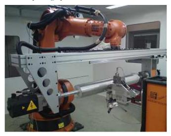
Figure 37: Machine d'enroulement filamentaire MF Tech
