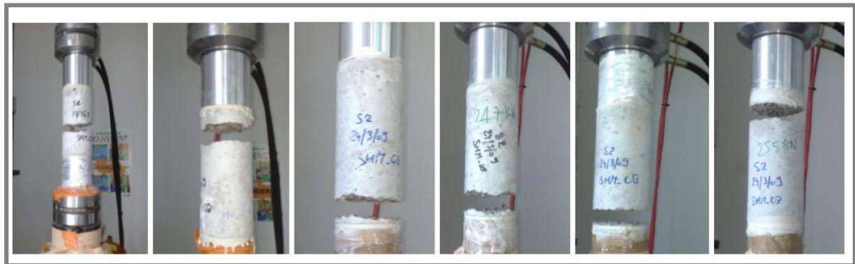
Figure 4.13 : Rupture des éprouvettes cylindriques en traction directe
