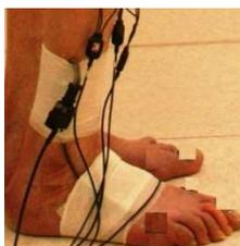
**Figure 40-Exemple de fixation du goniomètre sur le tibia et pied droit d'un sujet**
