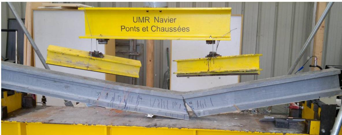
**Fig.4.26 Rupture de la poutre PP-JC8TT**
