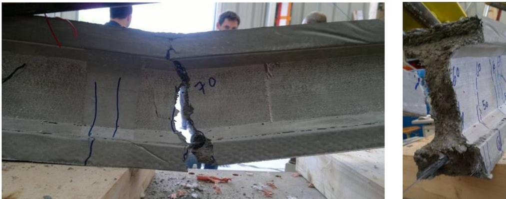
**Fig.4.22. Rupture de la poutre PP-JCU12 en flexion**
