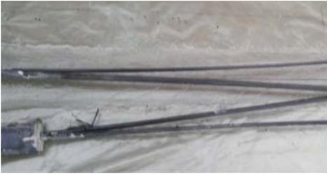
c) rupture par propagation de fente du jonc
