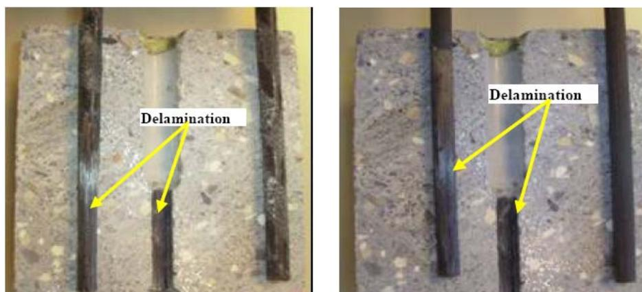
Fig.2.16 Rupture de l'adhérence jonc PRFC-BFUP par délaminage
