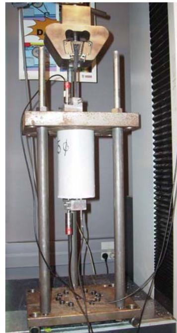
**Fig.2.6 Montage de l'essai de Pull-out**
