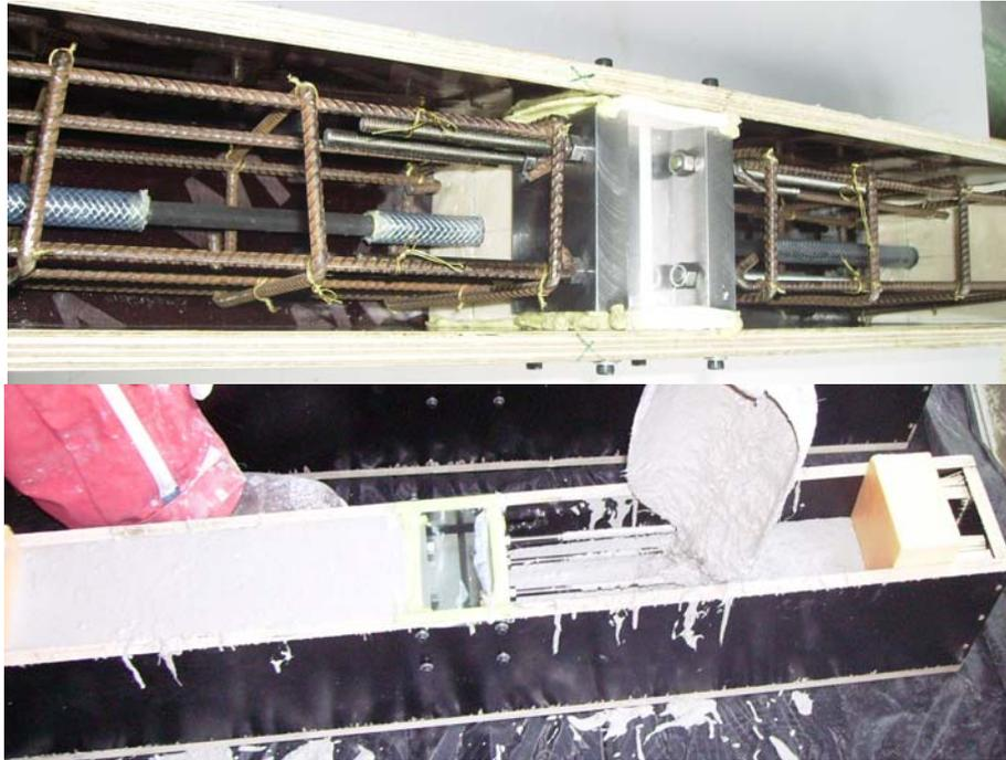
**Fig.2.31 Préparation des échantillons « beam test »**
