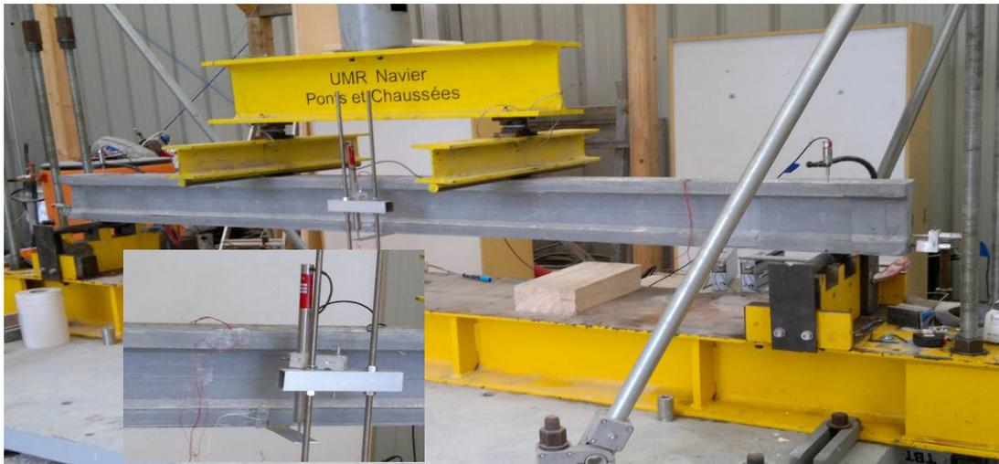
**Fig. 4.1** Le montage de l'essai de flexion
