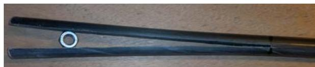
Fig.3.1 Fente longitudinale aux bouts du jonc carbone
