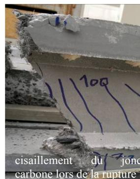
**Fig. 4.8 Rupture de la poutre PP-2JC8 par effort tranchant suivie par glissement et cisaillement des joncs**
