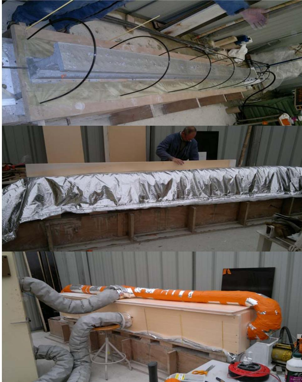
**Fig.3.22 Traitement thermique des poutres**
