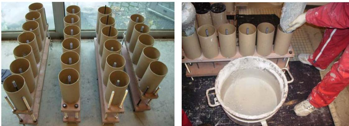
**Fig.2.5.** Préparation des spécimens de Pull-out
