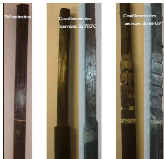
**Fig.2.29** Différents modes de rupture
