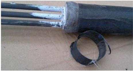
d) plastification du tube acier (épaisseur insuffisante)
