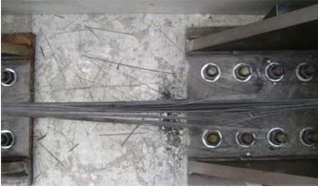
a) rupture du jonc carbone en traction
