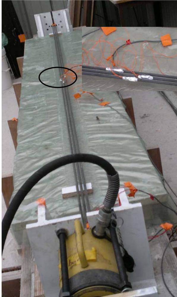
**Fig. 3.18** Mise en tension des renforts de précontrainte
