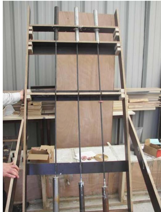
**Fig.3.4 Préparation des échantillons d'ancrage**
