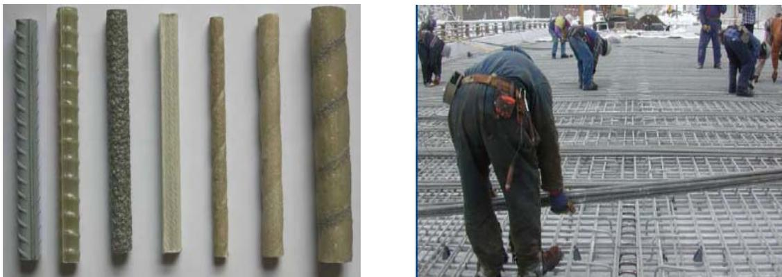
Fig.1.7 Barres en fibre de verre (PRFV)
