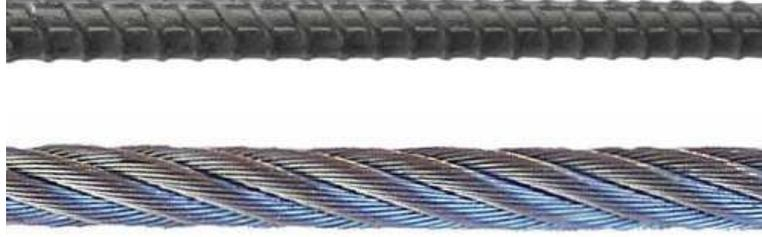
FIGURE 3.4 – Illustration de l'état de surface d'une barre d'armature (haut) et d'un câble en acier tressé (bas).
