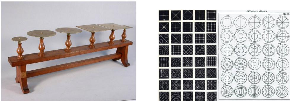
FIGURE I.6 – Dispositif expérimental utilisé par Chladni et modes propres observés pour des plaques carrées ou circulaires.
