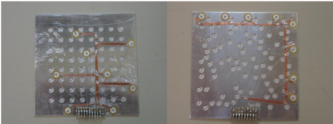
FIGURE III.19 – Photos des plaques équipées de 8 capteurs piézoélectriques.
