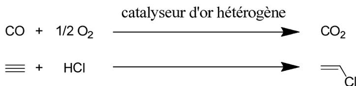
**Schéma 3: Procédés qui utilisent la catalyse hétérogène à l'or<sup>3</sup>**
