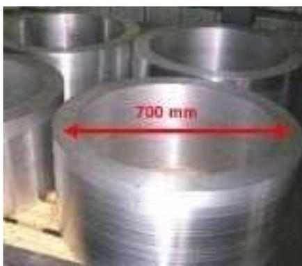
Figure 1 : Virole centrale du caisson-cœur du Réacteur expérimental Jules Horowitz avant soudage et usinage.
