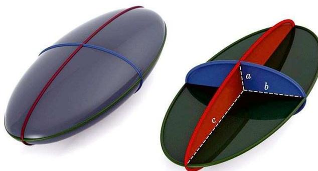
Figure 28 : Définition des longueurs caractéristiques des objets
