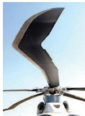
FIGURE 2.12: Pale Blue Edge<sup>TM</sup> utilisée par Eurocopter pour équiper ses nouveaux hélicoptères
