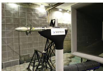
FIGURE 1.7: Banc d'essai Hera testé au DNW © Snecma
