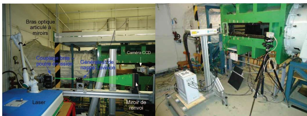
FIGURE 3.29: Montage du banc PIV A à la soufflerie S2L
