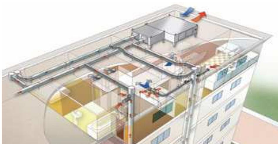
**Figure 9. Ventilation double flux en logement collectif**
