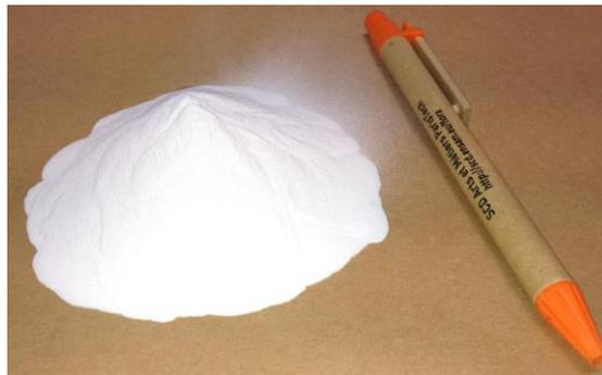
Figure 3 Poudre de PA12 utilisée par Dassault
