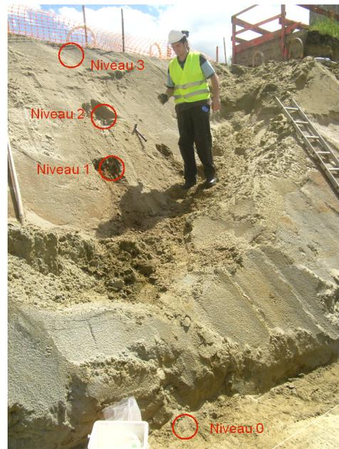
FIGURE 3.8 – Vue de l'emplacement des quatre carottages.
