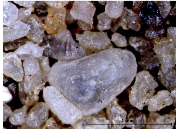
FIGURE 2.5 – Détail d'un grain de quartz au stéréomicroscope.
