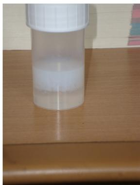
FIGURE 5.18 – Flocculation des colloïdes de polystyrène de 60 nm de diamètre dans une solution fortement saline.
