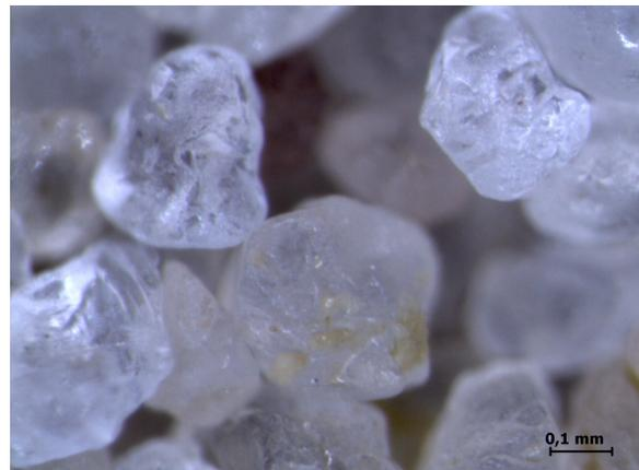
FIGURE 2.16 – Détail d'un grain de quartz au stéréomicroscope.
